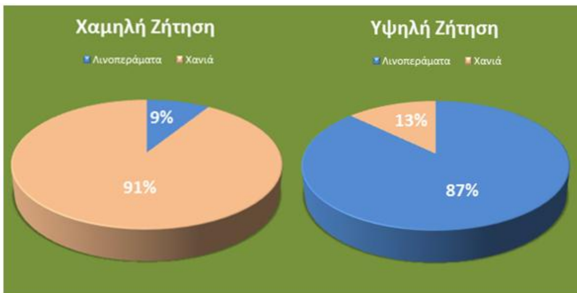
ΔΙΑΓΡΑΜΜΑ 54 ΚΑΤΑΝΟΜΗ ΤΗΣ ΜΕΤΑΒΟΛΗΣ ΤΗΣ ΠΑΡΑΓΩΓΗΣ ΤΩΝ ΣΤΑΘΜΩΝ ΠΑΡΑΓΩΓΗΣ ΣΕ ΧΑΜΗΛΗ ΚΑΙ ΥΨΗΛΗ ΖΗΤΗΣΗ.
