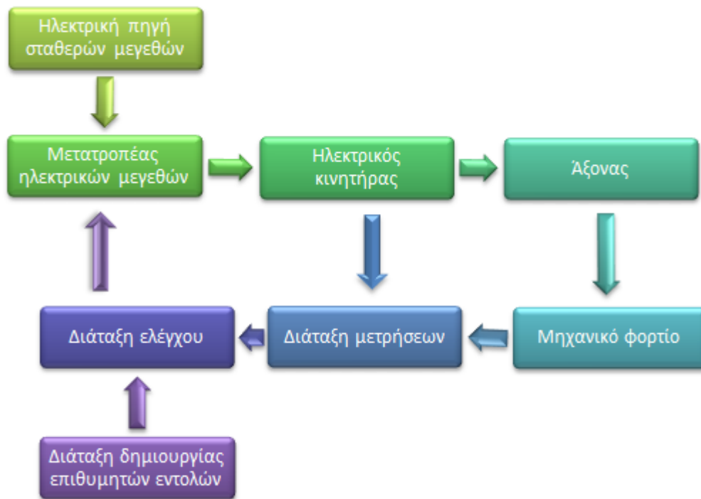
ΔΙΑΓΡΑΜΜΑ 25 ΒΑΣΙΚΗ ΔΟΜΗ ΕΝΟΣ ΕΛΕΓΧΟΜΕΝΟΥ ΗΛΕΚΤΡΟΚΙΝΗΤΗΡΙΟΥ ΣΥΣΤΗΜΑΤΟΣ [4]
