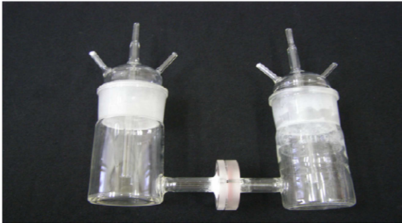
Σχήμα. 5.8 Φωτογραφία ενός κατάλληλου εργαστηριακού διαμορφωμένου PEC αντιδραστήρα από πυρίμαχο γυαλί. Η μεμβράνη μεταφοράς ιόντων βρίσκεται στη μέση.
