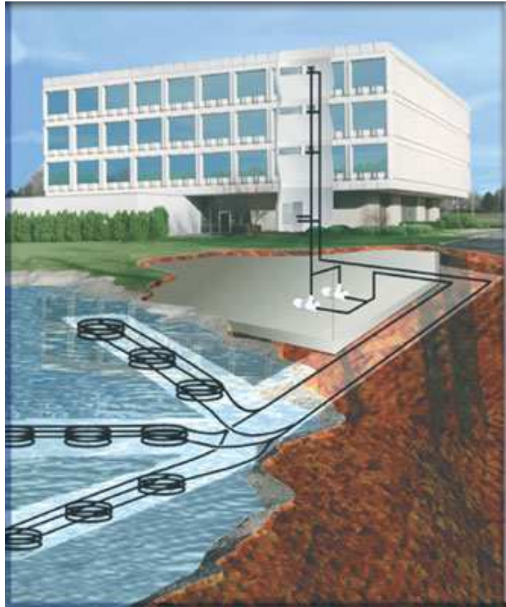
Σχήμα 43-α Σύστημα οριζόντιου εναλλάκτη σε λίμνη
