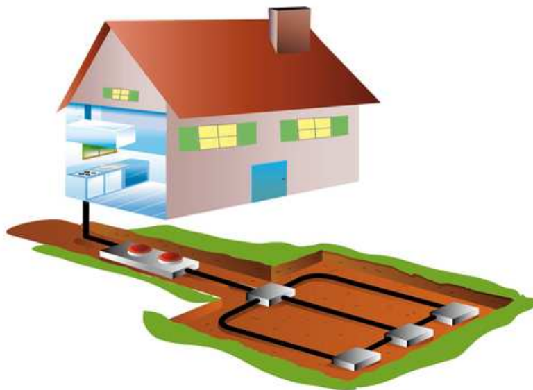
Σχήμα 43-β Σύστημα οριζόντιου εναλλάκτη σε έδαφος
