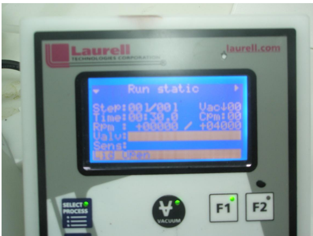
Εικόνα 4.7: Οι απαραίτητες ρυθμίσεις για εναπόθεση PEDOT:PSS
