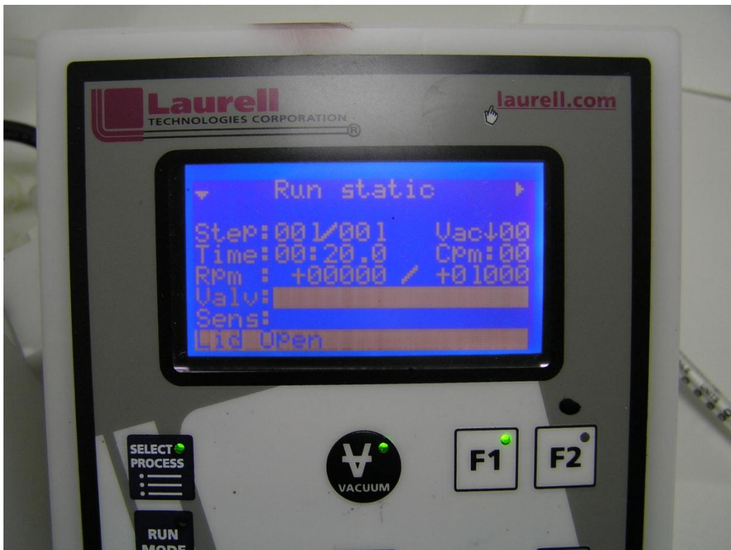
Εικόνα 4.11: Οι απαραίτητες ρυθμίσεις για εναπόθεση Active layer
