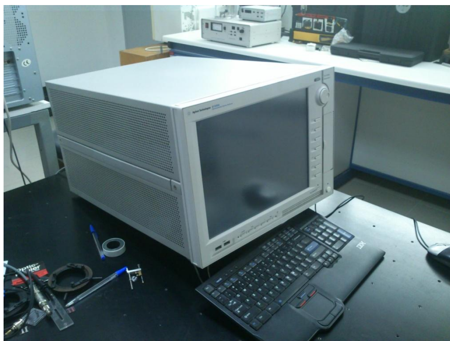
Εικόνα 5.3: Η/Υ B1500AN (Semiconductor Analyzer)
