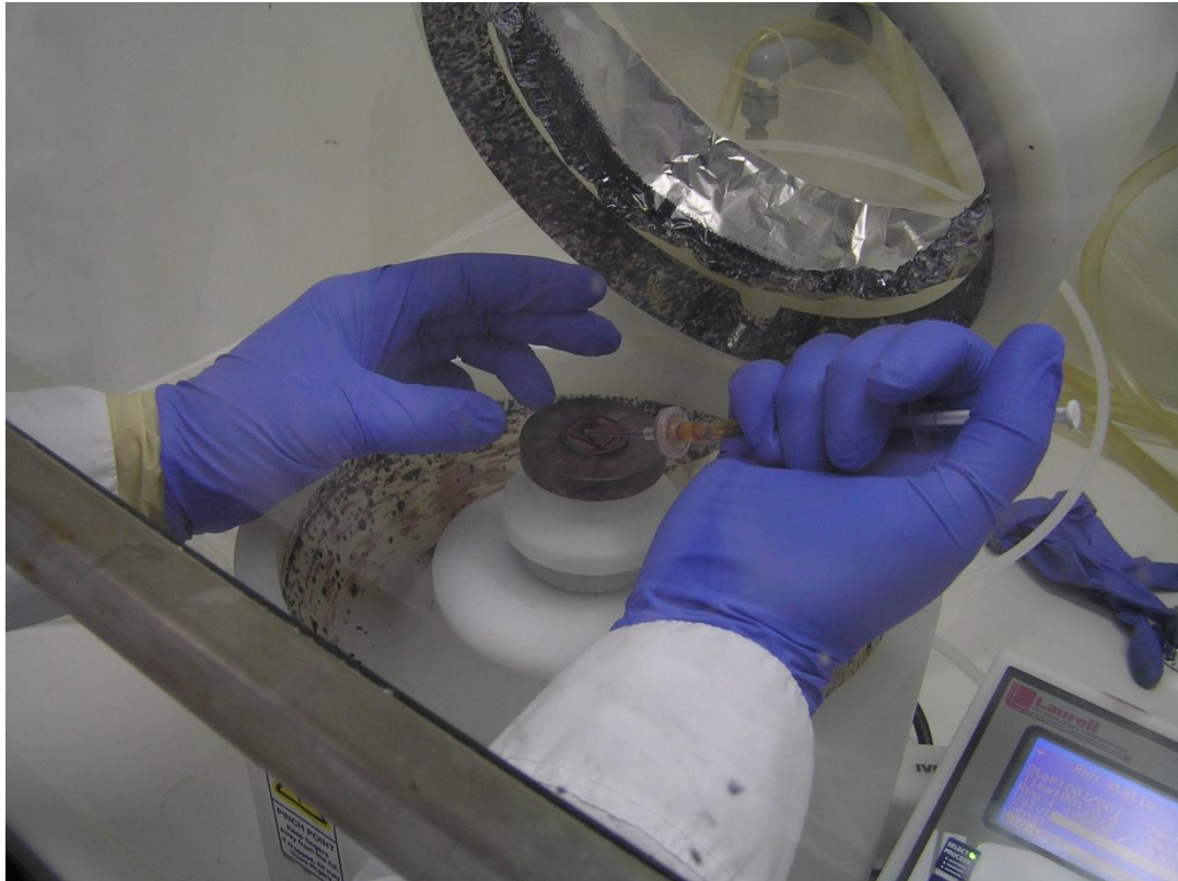
Εικόνα 4.10: Ρίψη σταγόνων Active layer πάνω στο δοκίμιο
