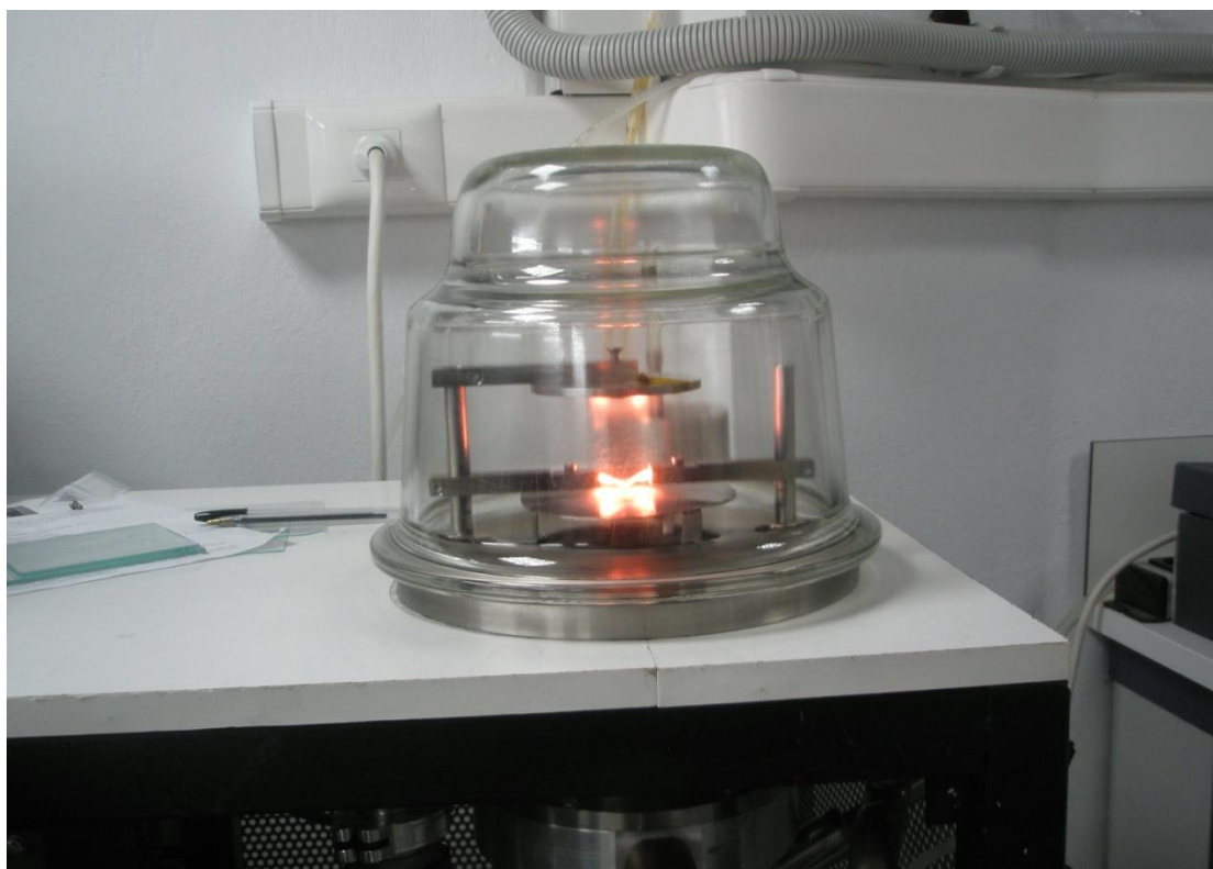
Εικόνα 4.24: Η στιγμή της εξάχνωσης (Evaporation).
