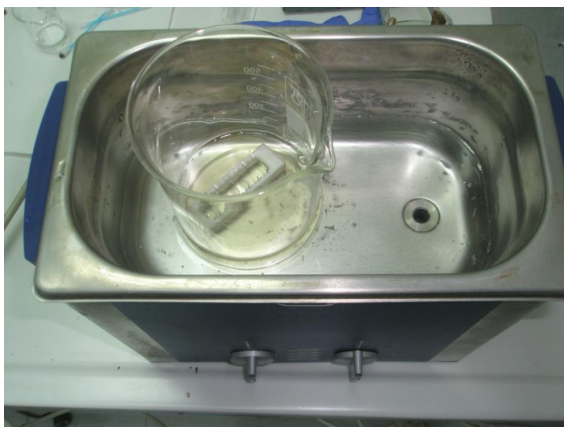
Εικόνα 4.2: Τα δοκίμια, όπως τοποθετούνται στην συσκευή Ultrasonic Bath.
