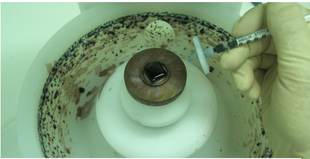
Εικόνα 4.6: Κάλυψη του δοκιμίου με PEDOT:PSS, πριν τη περιστροφή.
