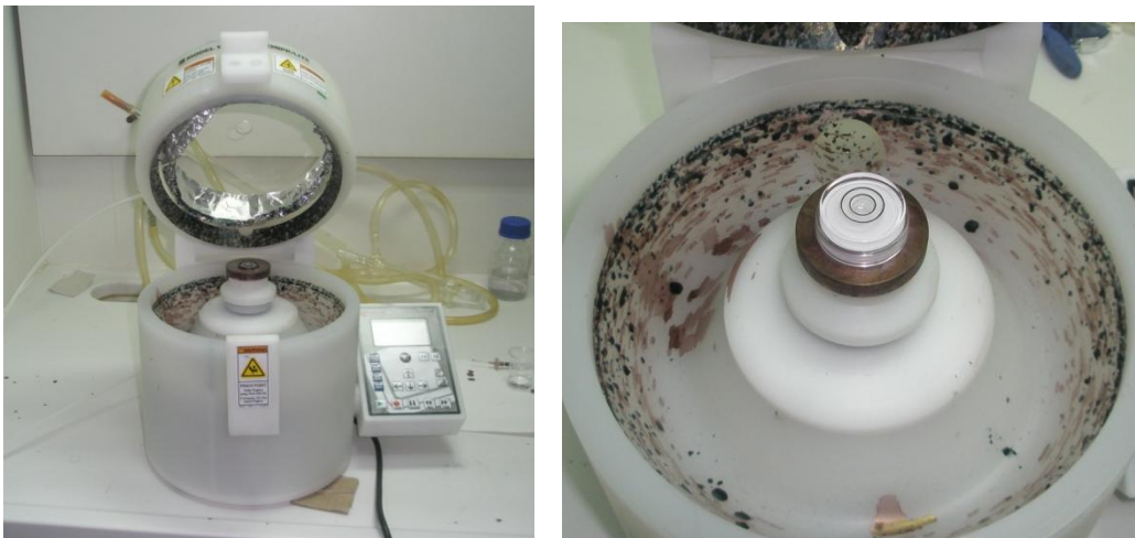
Εικόνα 4.5: Η συσκευή spin coater.
