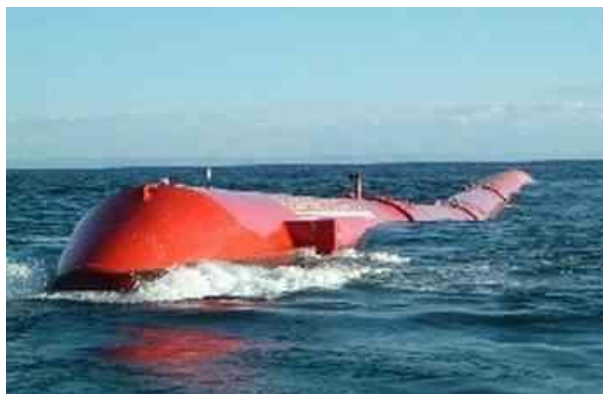
Εικόνα 2-10: Το Pelamis σε λειτουργία. Το πρότυπο είναι τοποθετημένο στο European Marine Energy στο Orkney της Σκωτίας.
