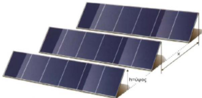
Εικόνα 3-25: Απόσταση μεταξύ συστοιχιών για αποφυγή σκιάσεων
