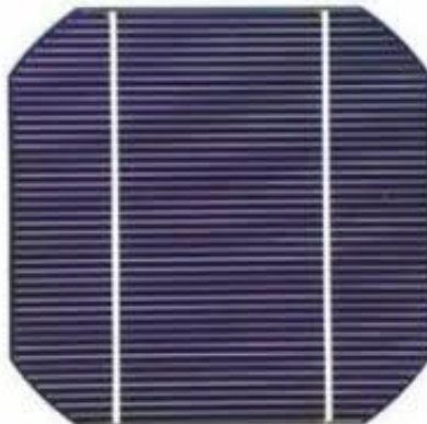
Εικόνα 3-12: Φ/Β στοιχείο μονοκρυσταλλικού πυριτίου
