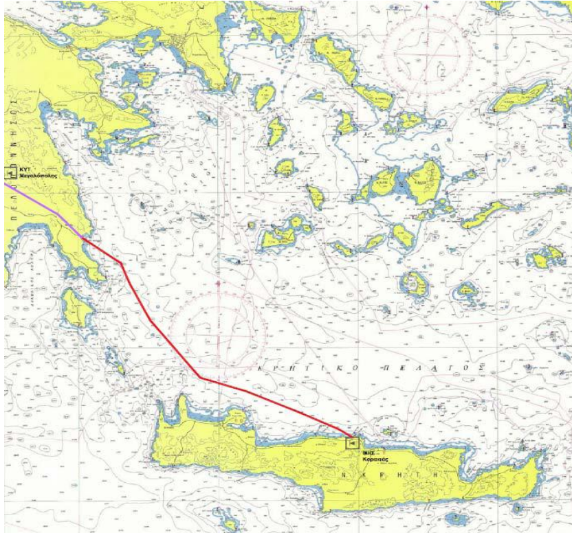
Εικόνα 5-6: Διασύνδεση της Κρήτης με το Ηπειρωτικό Σύστημα – προτεινόμενο σενάριο σχετικής μελέτης για τις ανάγκες της Ρ.Α.Ε.
