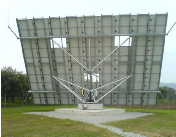
Εικόνα 3-35: Οπίσθια όψη διαξονικού συστήματος tracker (της εταιρίας MechatronABEE)
