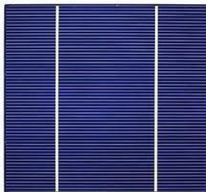
Εικόνα 3-13: Φ/Β στοιχείο πολυκρυσταλλικού πυριτίου
