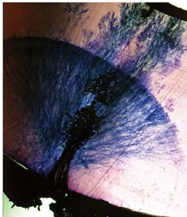
Εικόνα 9: καλώδιά χλρε μόνωσης που καταστράφηκαν λόγω ανωμάλιων στην μόνωση τους και διείσδυσης νερού σε αυτά.
