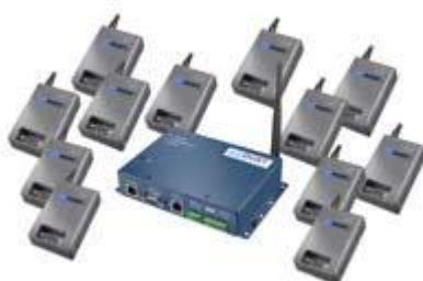
Εικόνα 4.1: Smart Dust. Πολλοί αισθητήρες που επικοινωνούν με ένα σταθμό βάσης.
