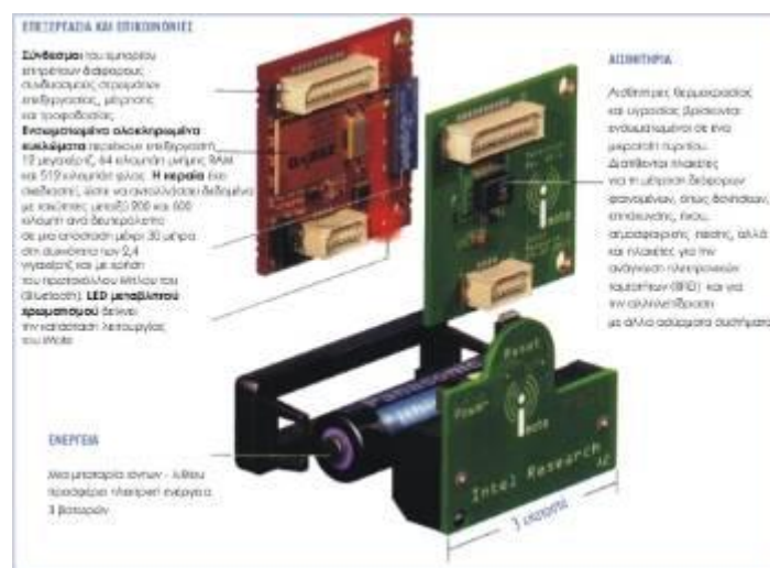
Εικόνα 4.4: Το πρωτότυπο έξυπνου αισθητήρα που κατασκεύασε η Intel είναι δομημένο σε στρώματα, ώστε με κατάλληλο συνδυασμό εξαρτημάτων να προκύπτει η επιδιωκόμενη λειτουργικότητα
