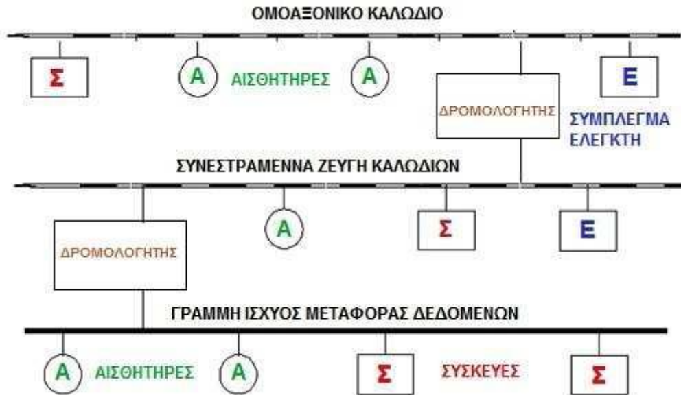
Σχήμα 3,24 : Παράδειγμα Cebus Τοπολογία
