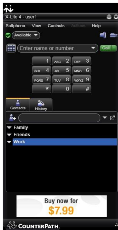
Εικόνα 5.54 Το web GUI του X-Lite, μετά την επιτυχή εγγραφή σε κάποιο SIP Server
