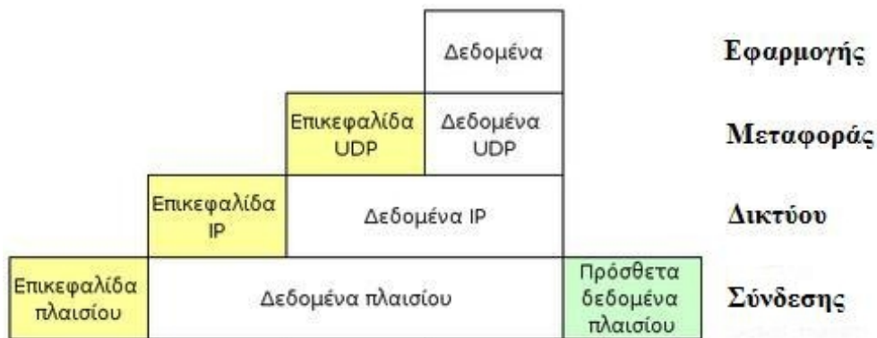
Εικόνα 2.5 Ενθυλάκωση κεφαλίδων σε κάθε επίπεδο στο βασικό πακέτο δεδομένων
