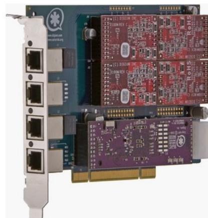
Εικόνα 4.7 Κάρτα όμοια με την προηγούμενη, αλλά νεότερου τύπου σειράς TDM410 με επιπλέον δυνατότητα για υποδοχή hardware echo cancellation module
