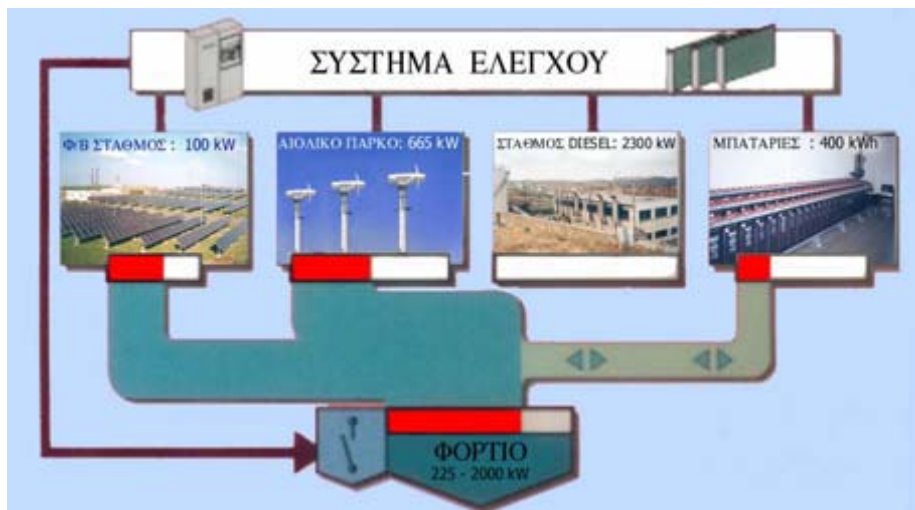
Εικόνα 2: Σχηματική παράσταση λειτουργίας του υβριδικού συστήματος της Κύθνου με κάλυψη των αναγκών του νησιού 100 % από ΑΠΕ . (Πετρελαϊκές μονάδες εκτός λειτουργίας)
