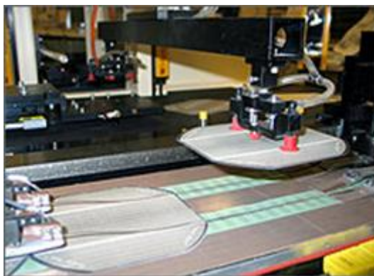
Εικόνα 1: Φωτοβολταϊκά στοιχεία κατά τη συναρμολόγηση του πλαισίου.
