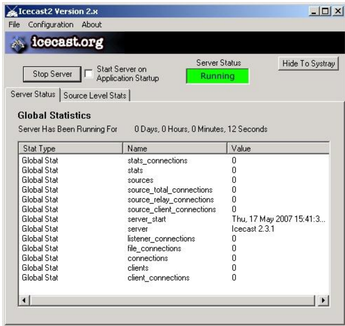
Εικόνα 2.4.12. Με το που πατήσουμε το “Start Server” εμφανίζονται όλοι οι server και βλέπουμε ότι είναι ενεργοποιημένοι από το “Server Status”→Running. Εάν στέλνουμε εικόνα ή ήχο σε κάποιον από αυτούς τους server στην στήλη “Value” θα υπάρχει η ένδειξη 1 αντί για 0.
