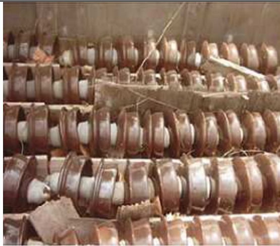
Σχήμα 1.15.α. Πορσελάνινοι μονωτήρες τύπου ομίχλης 150 kV.
