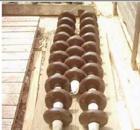
Σχήμα 1.16 Πορσελάνινοι μονωτήρες κανονικού τύπου.
