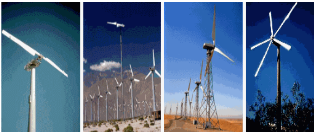
2 πτερύγια, 3 πτερύγια-κυλινδρικός πύργος, 3 πτερύγια-δικτυωτός πύργος, 5 πτερύγια Σχήμα 16 Διάφοροι τύποι ανεμογεννήτριες οριζόντιου άξονα (Πηγή NREL).
