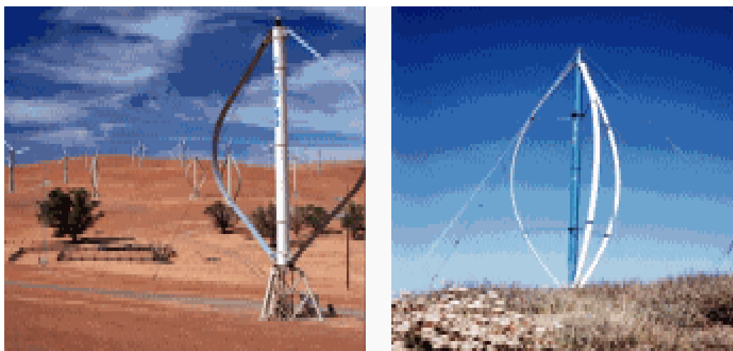
Σχήμα 17 Διάφοροι τύποι ανεμογεννήτριες κατακόρυφου άξονα (Πηγή NREL).
