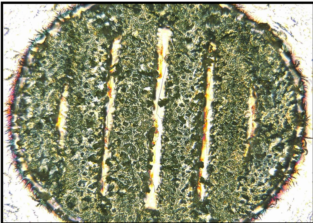
Εικόνα 27 Μικροσκοπική απεικόνιση Shunt σε οργανικό φωτοβολταϊκό.
