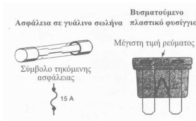
Εικόνα 31: Συσκευές προστασίας κυκλωμάτων
