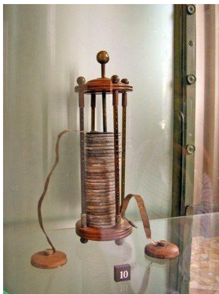
Εικόνα 18: Βολταϊκός σωρός από τον Alessandro Volta περι το 1800
