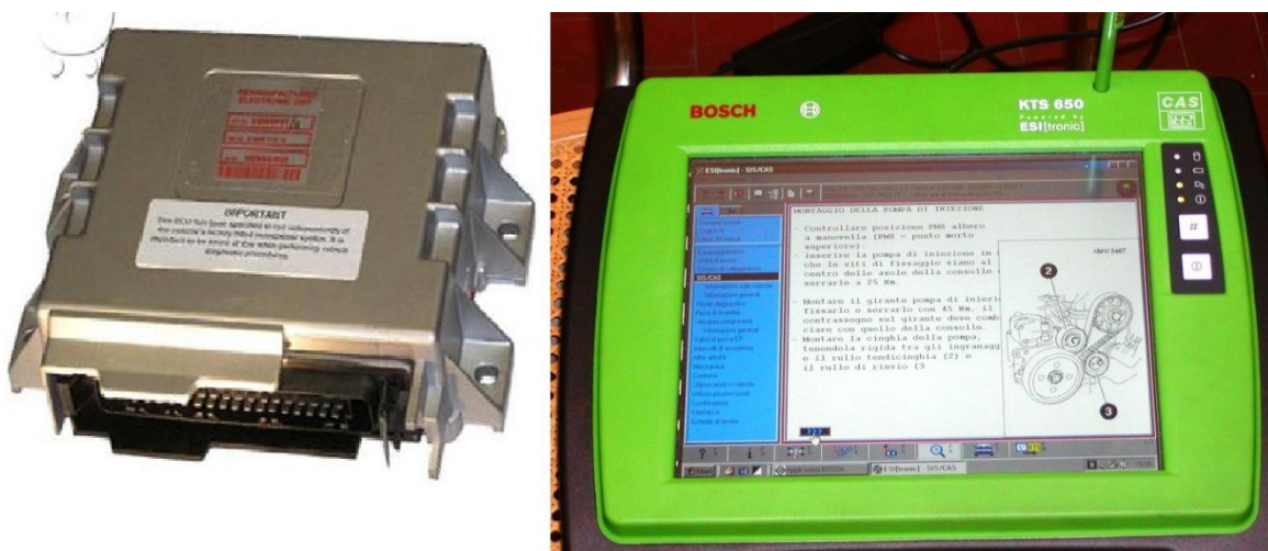
Εικόνα 57: Εγκέφαλος αυτοκινήτου και tester διαγνωστικό βλαβών εγκεφάλου.
