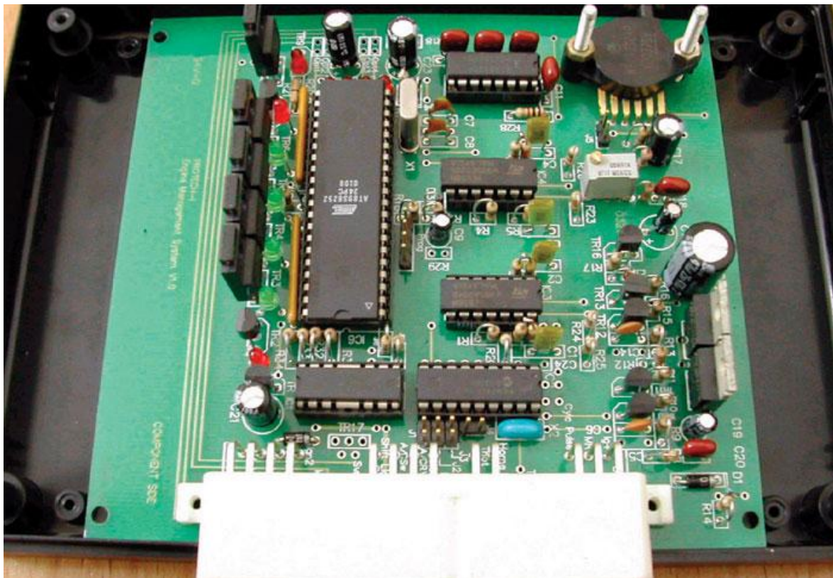
Εικόνα 55:Εσωτερικό εγκέφαλου αυτοκινήτου
