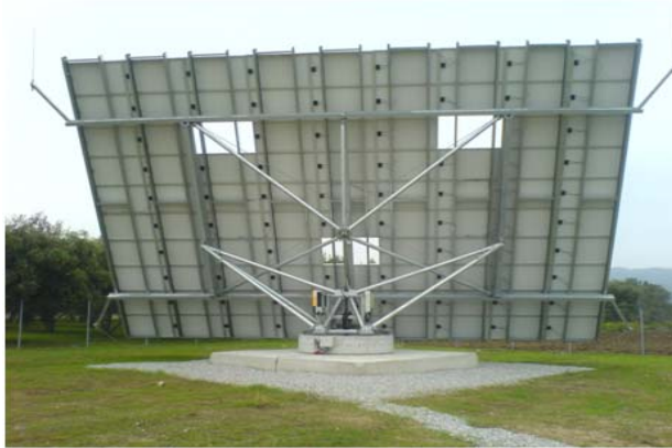
Εικόνα 3.31: Οπίσθια όψη διαξονικού συστήματος tracker (της εταιρείας MechatronABE ) 23
