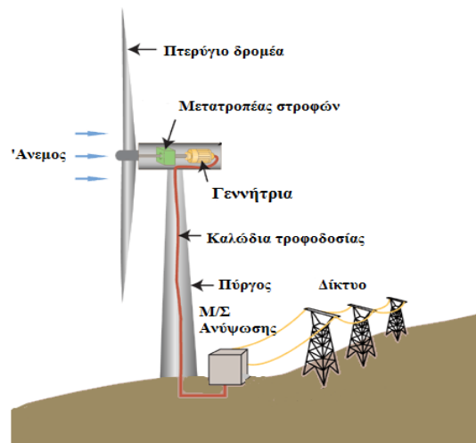
Εικόνα 2.2: Τυπική σχηματική διάταξη Ανεμογεννήτριας
