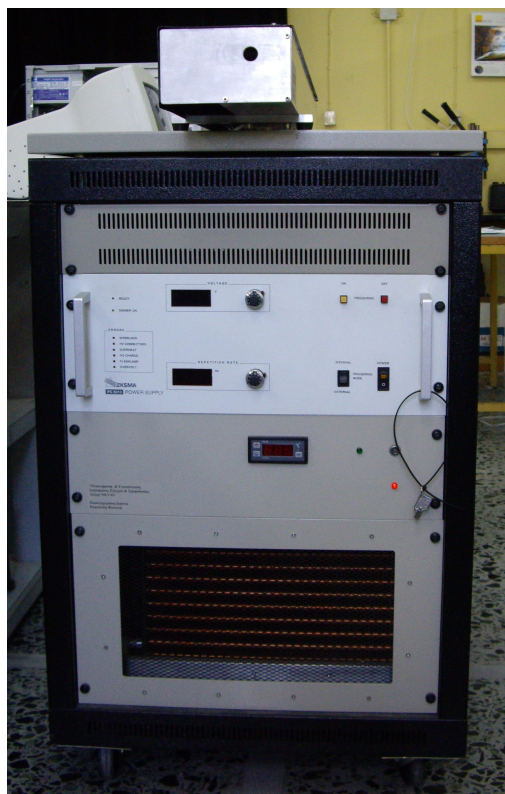
Εικόνα 7.1. Το Nd:YAG laser που χρησιμοποιήθηκε για τα πειράματα.
