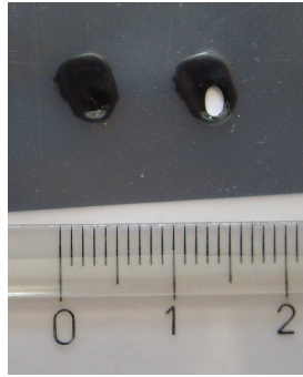
Εικόνα 7.7. Απεικόνιση μεγέθους του ίχνους των συγκολλήσεων.
