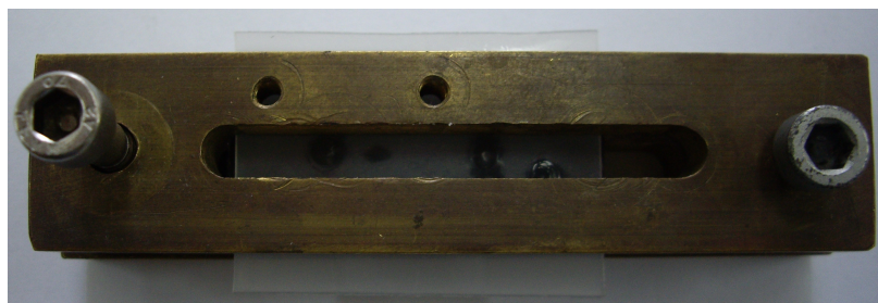
Εικόνα 7.5. Διάταξη συγκράτησης-συγκόλλησης παχύτερων φύλλων πλαστικού.
