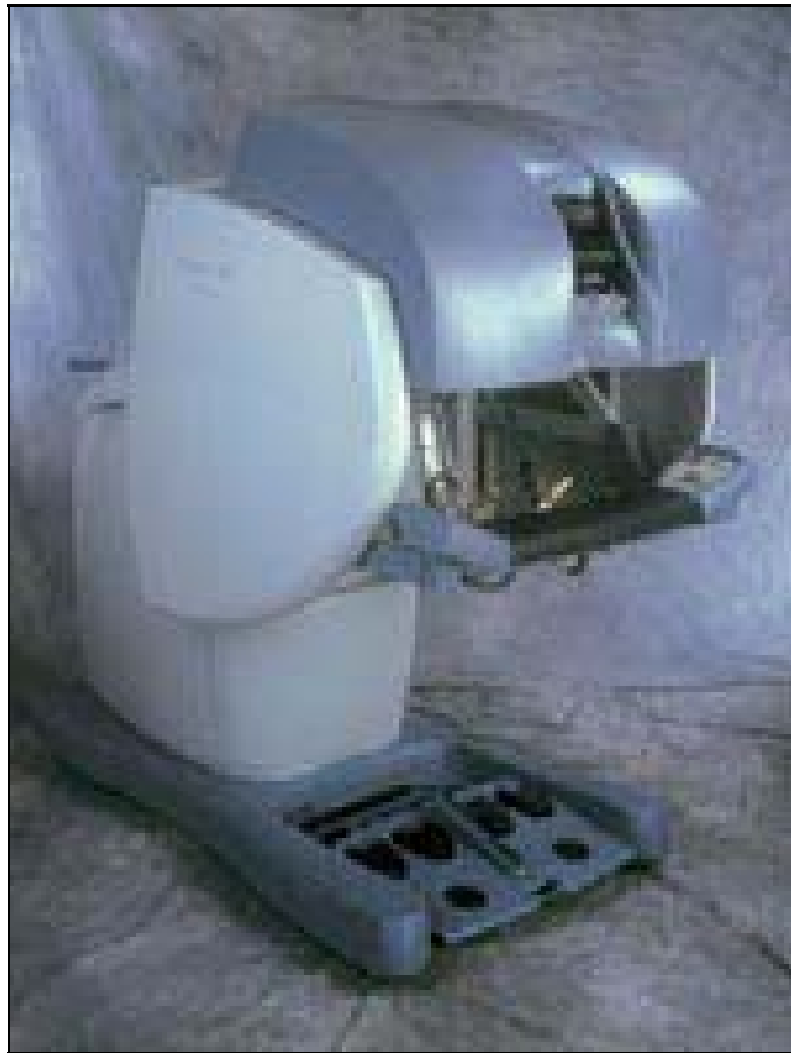
Εικόνα 35. Κονσόλα ελέγχου ρομποτικού συστήματος da Vinci.
