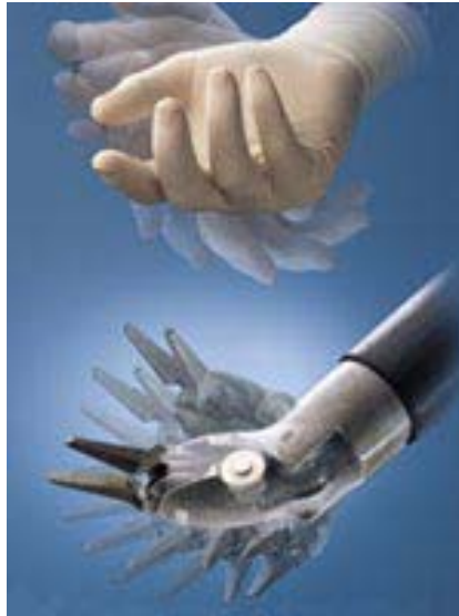
Εικόνα 45. Εργαλείο τεχνολογίας EndoWrist ικανό να μιμηθεί τις κινήσεις του ανθρώπινου καρπού.
