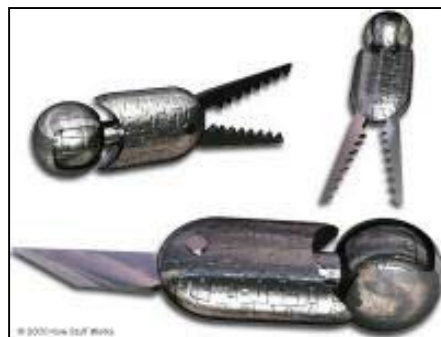
Εικόνα 28. Διάφορα είδη τελικών εργαλείων π.χ. αρπάγη, νυστέρι.
