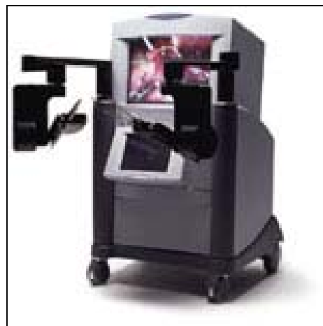
Εικόνα 66. Κονσόλα ελέγχου Zeus τεχνολογίας MicroWrist.
