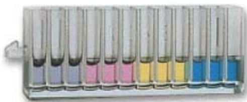
Σχ.1 Η δυνατότητα φόρτωσης κυβετών, χωρίς να διακόπτεται η ανάλυση, σε συνδυασμό με την δυνατότητα αποθήκευσης κυβετών, προσδίδουν στον αναλυτή αυτονομία εργασίας
