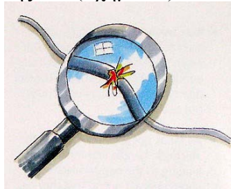
Προσεκτικός έλεγχος καλωδίου ουδετέρου ηλεκτροδίου ΣΧΗΜΑ 73
