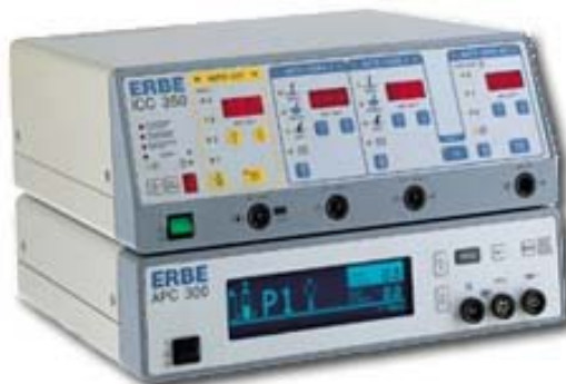
Σύστημα πηγής αερίου αργού και γεννήτριας υψίσυχων ρευμάτων ΣΧΗΜΑ 21
