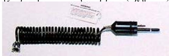
Συσκευή ελέγχου διαρροής ΣΧΗΜΑ 92
