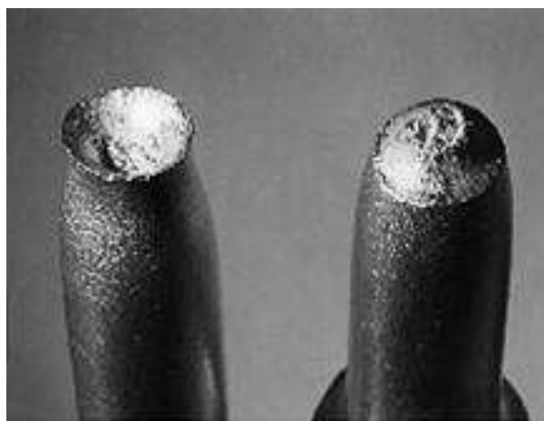
(photo 3: Θραύση όλκιμου υλικού)
