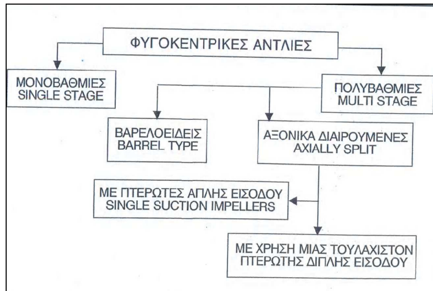
Σχ. 22 Υποδιαίρεση φυγόκεντρικών αντλιών ως προς τις βαθμίδες
