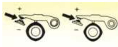
Εικόνα 8.5.2: Αφαίρεση υλικού από τις πλατίνες ανάλογα με την τιμή της χωρητικότητας του πυκνωτή.
