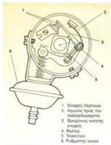
Εικόνα 8.4.2: Διακοπτής Χ.Τ. του διανομέα (α) και γωνία επαφής Dwell (β)
