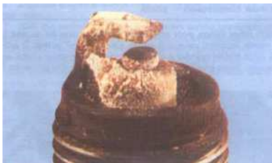
Εικόνα 7.7.2: Υπερβολική ύπαρξη λαδιού στο θάλαμο καύσης ή χρήση χαμηλής ποιότητας λαδιού.
