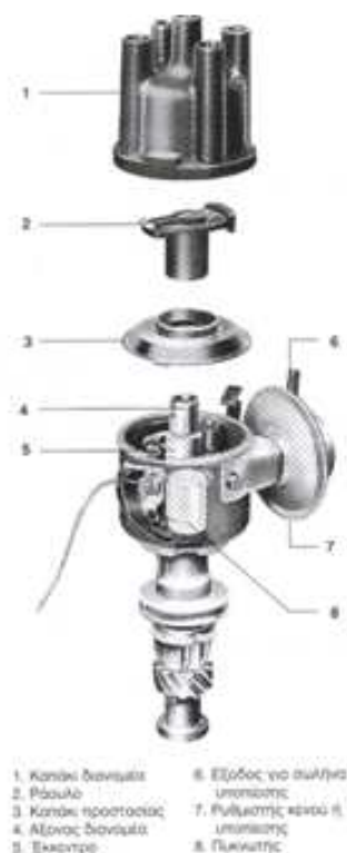
Εικόνα 8.3.1: Διανομέας με εκτεταμένο άξονα
