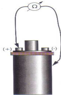
Εικόνα 7.6.2: Έλεγχος της μόνωσης του πρωτεύοντος τυλίγματος.
