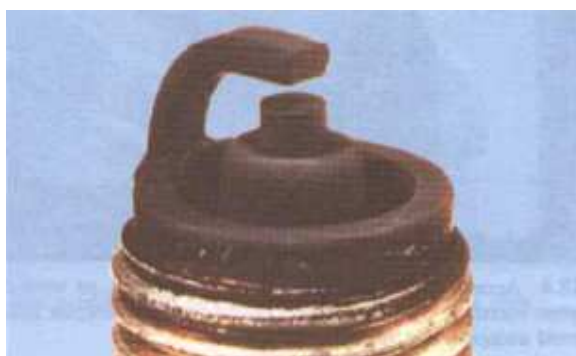
Εικόνα 7.7.3: Υπερβολικά πλούσιο μίγμα αέρα-βενζίνης, ή βλάβη στο σύστημα ανάφλεξης.
