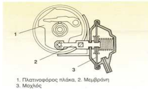
Εικόνα 8.8.3: Πλατινοφόρος πλάκα μετατοπίζεται ως προς το έκκεντρο ανάλογα προς τη θέση της μεμβράνης και κατά τη φορά αντίθετη της περιστροφής του έκκεντρου.
