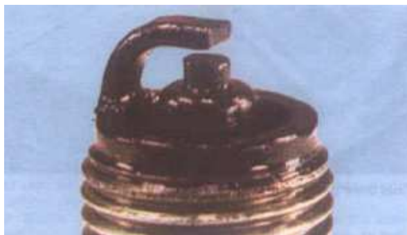
Εικόνα 7.7.4: Πολύ φθαρμένη μηχανή ή βλάβη στο σύστημα ανάφλεξης.
