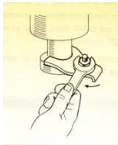
Εικόνα 8.7.5: Διανομέας (α) και σφίξιμο βίδας στη βάση του διανομέα (β)
