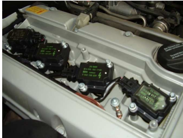
Εικόνα 2.13.2: Κινητήρας με 1 πολ/στη ανά κύλινδρο.
