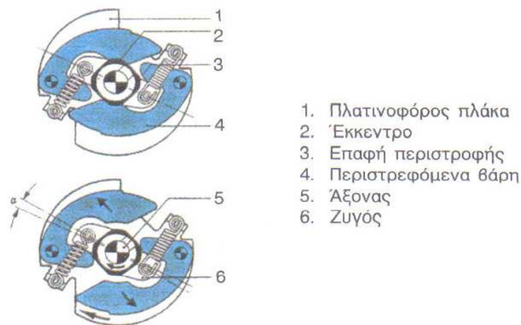
Εικόνα 1.1.10: Φυγοκεντρικός μηχανισμός.
