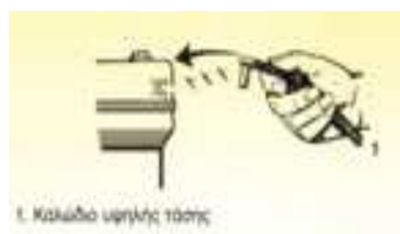
Εικόνα 8.5.3: Πρακτικός έλεγχος της δευτερεύουσας περιέλιξης του πολλαπλασιαστή.
