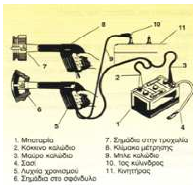
Εικόνα 8.7.1: Ρύθμιση γωνίας προπορείας αβάνς με τον κινητήρα σε λειτουργία.
