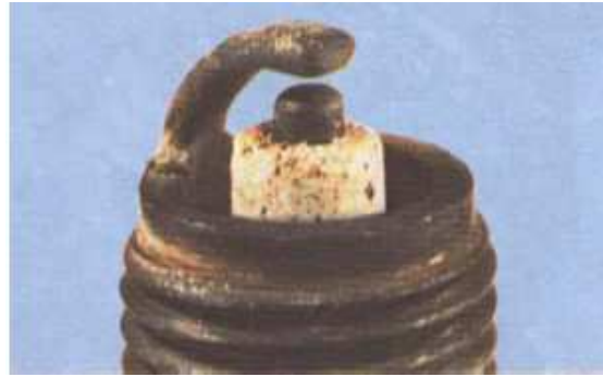
Εικόνα 7.7.5: Εκτενή πρόοδος του χρόνου ανάφλεξης ή βλάβη στο σύστημα ψύξης.
