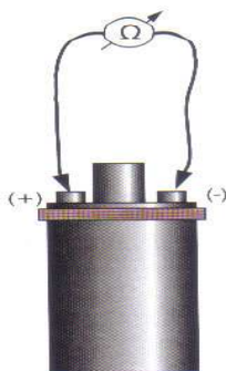
Εικόνα 7.6.1: Έλεγχος της ωμικής αντίστασης του πρωτεύοντος τυλίγματος (+15 και -1).
