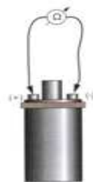
Εικόνα 8.2.2: Έλεγχος ωμικής αντίστασης του πρωτεύοντος τυλίγματος( +15 και -1).
