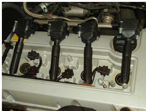
Εικόνα 2.13.3: Ο ίδιος κινητήρας καθώς έχουν αφαιρεθεί οι πολλαπλασιαστές.
