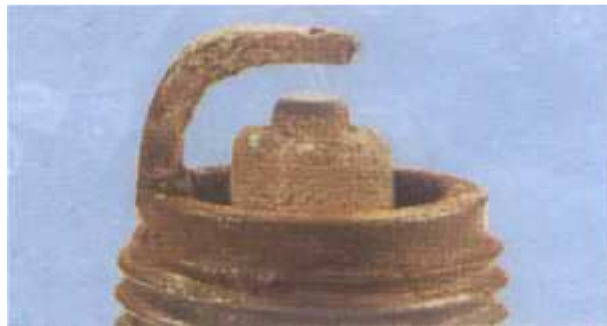
Εικόνα 7.7.6: Φαγωμένο και τριμμένο μέτωπο μπουζί.
