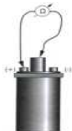
Εικόνα 8.2.4: Έλεγχος ωμικής αντίστασης του δευτερεύοντος τυλίγματος.
