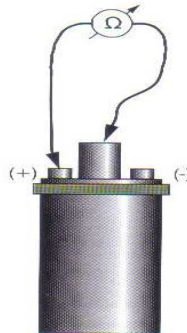
Εικόνα 7.6.3: Έλεγχος της ωμικής αντίστασης του δευτερεύοντος τυλίγματος.
