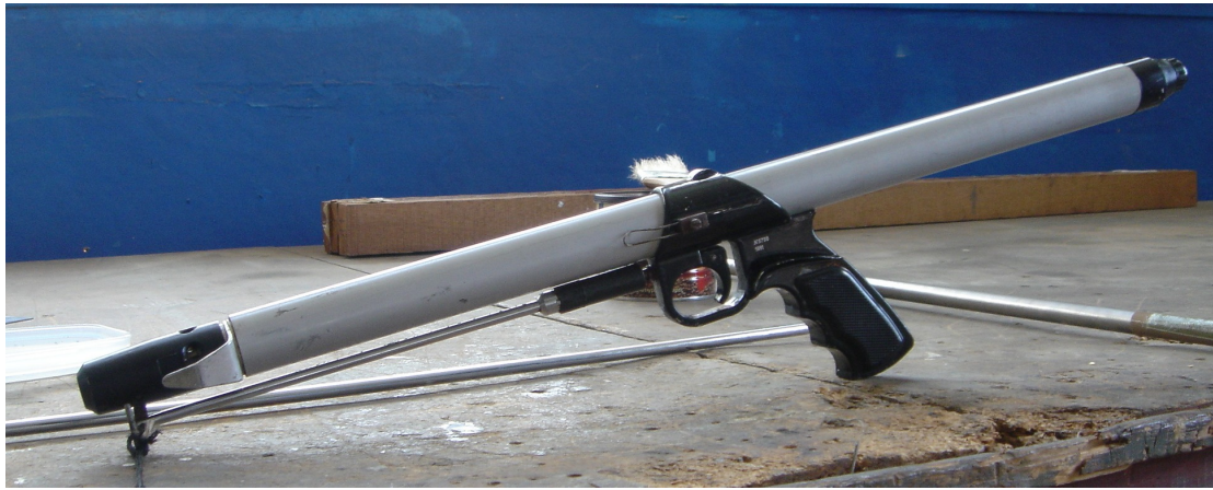
(Εικόνα 15 Όπλο τεχνολογίας Περίόδου 1970-'80. Όπλο με παρόμοια λειτουργία ενός αεροβόλου όπλου μόνο που στην προκειμένη περίπτωση ο προωστικός μηχανισμός είναι ένα ελατήριο )
