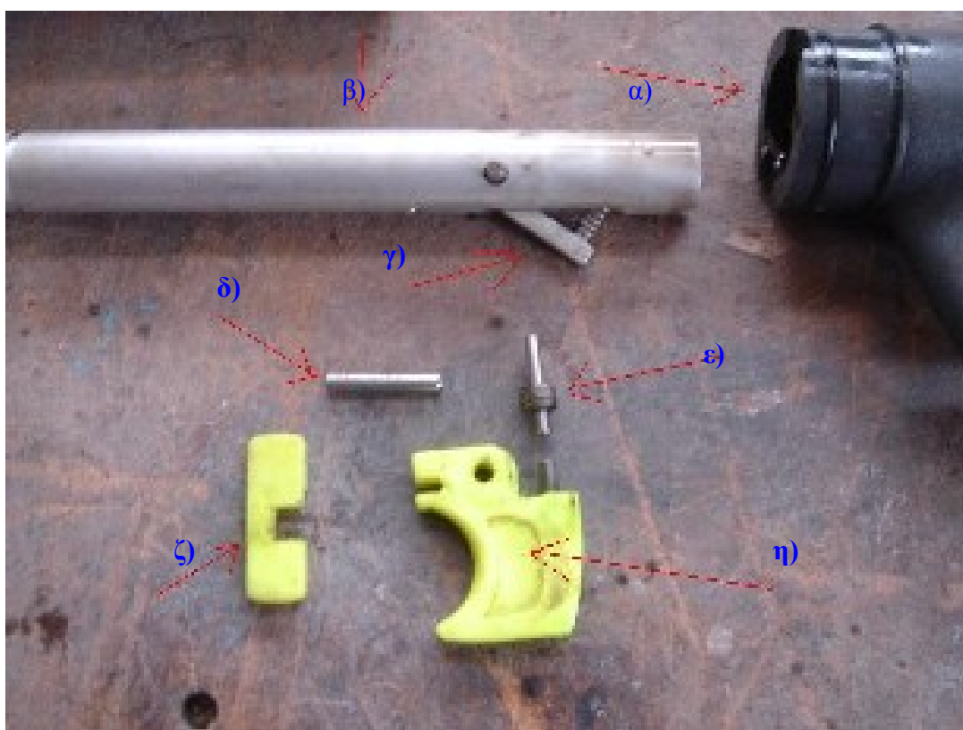
(Εικόνα 9 α)Λαβή, β)Οδηγός, γ)Κοκοράκι, δ)Πύρος στήριξης, ε)Πύρος σκανδάλης, ζ)Σκανδάλη, η)Ασφάλεια)
