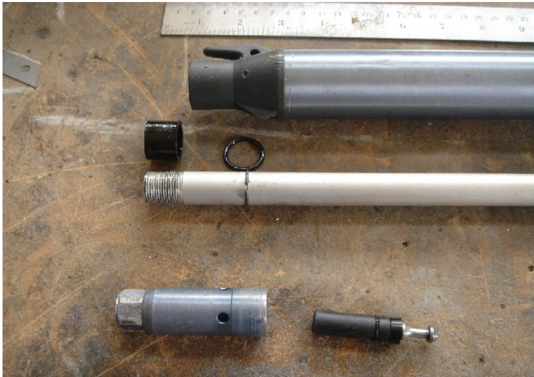
(Εικόνα 7-8 όλα τα μέρη της κεφαλής του όπλου)
