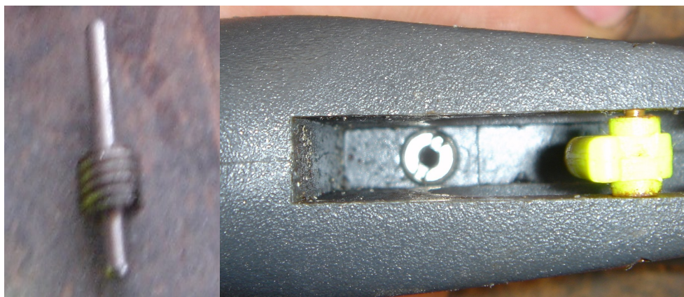
( Εικόνα 10 Πύρος σκανδάλης και τρόπος σύνδεσης)
