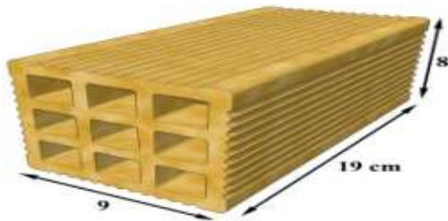
Εικόνα 3.1 Εξάοπο με διαστάσεις 6*8*19 εκατοστά
