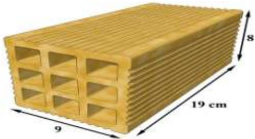
Εικόνα 1.10 Μικρά τούβλα εννιάοπα με διαστάσεις 9*8*19 εκατοστά
