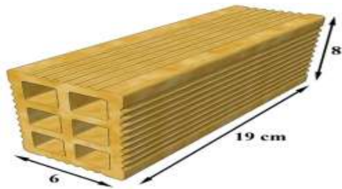
Εικόνα 1.9 Μικρά τούβλα εξάοπα με διαστάσεις 6*8*19 εκατοστά
