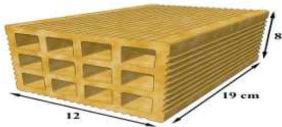
Εικόνα 1.12 Μεγάλα τούβλα δωδεκάοπα με διαστάσεις 9*12*19 εκατοστά
