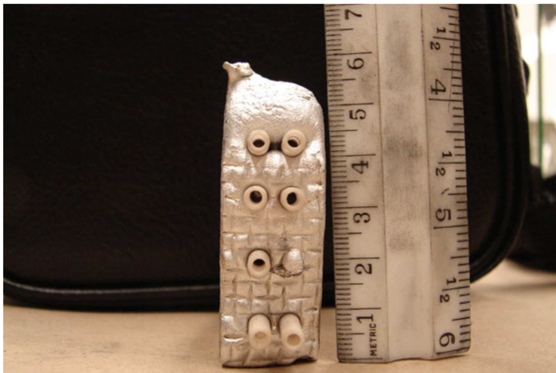
Εικόνα 11 Εμπρόσθια όψη του αυτόθεραπευόμενου σύνθετου υλικού (Nosonovsky et al. 2009)
