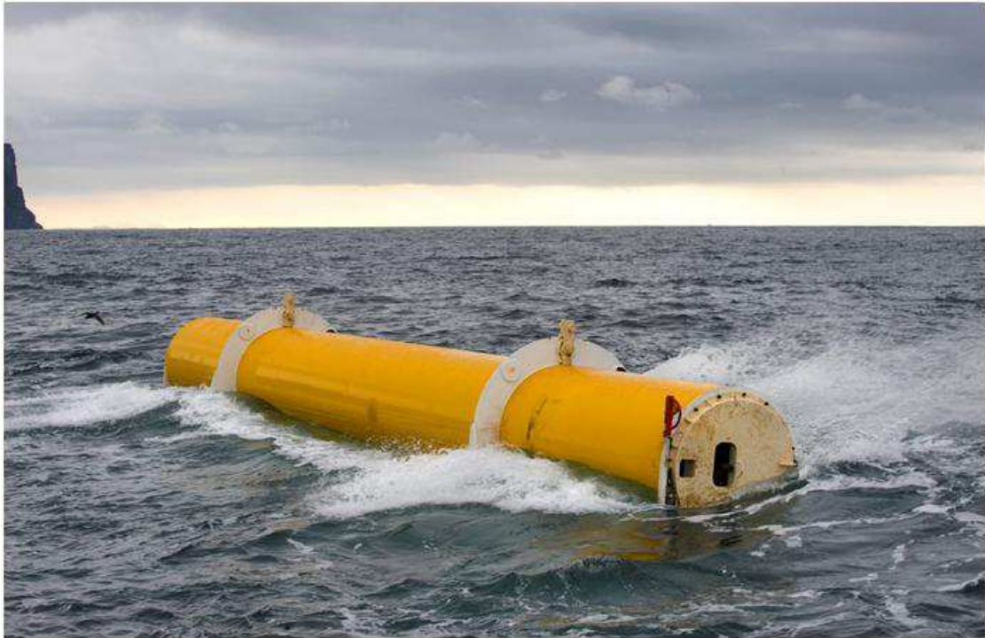
Εικόνα 7: Γεννήτρια που εκμεταλλεύεστε την ορμή των κυμάτων.
