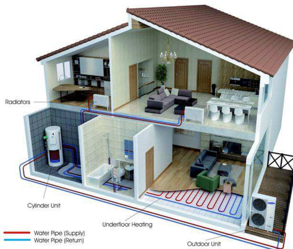
Εικόνα 9: Διώροφη κατοικία με ενδοδαπέδια θέρμανση
