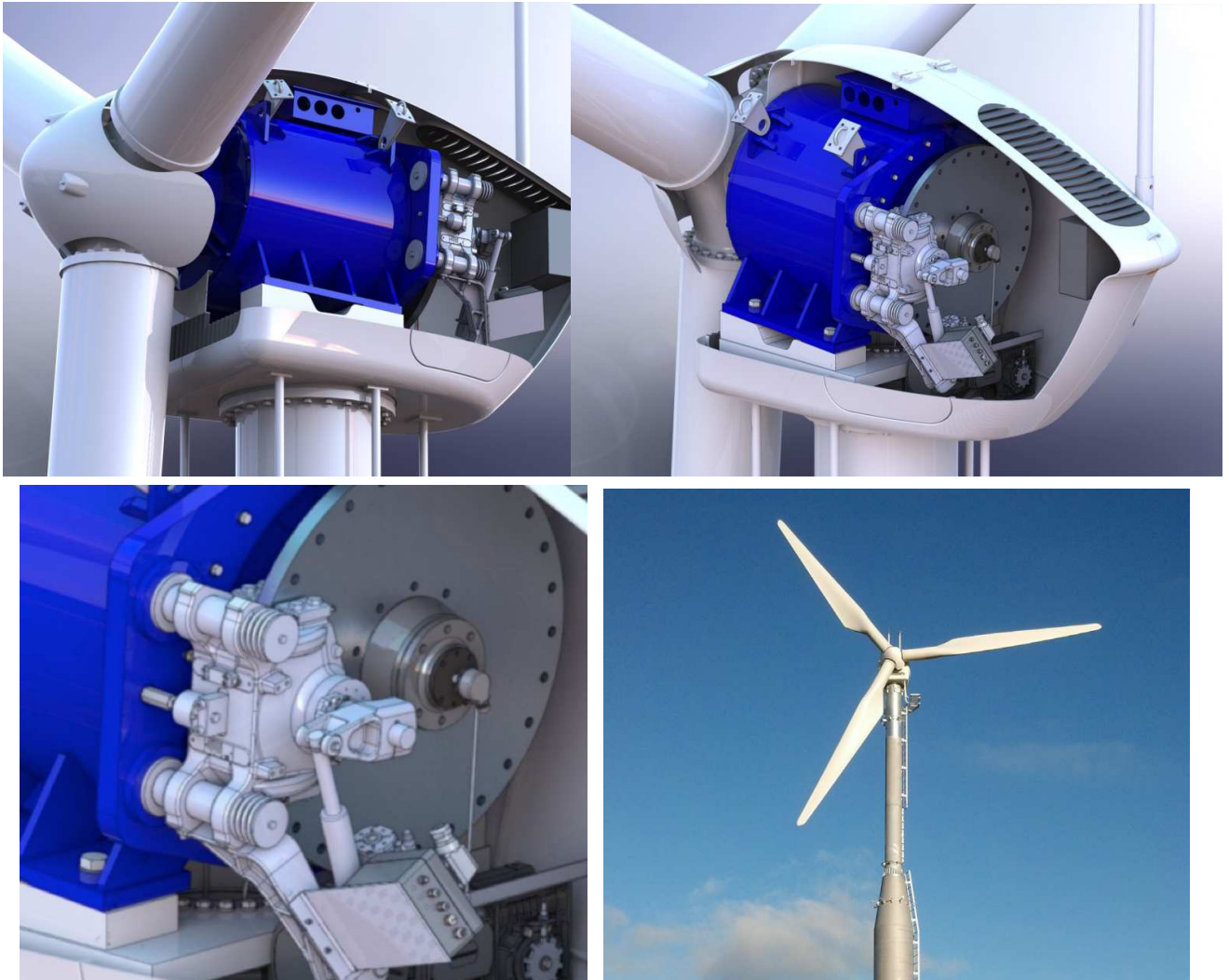
Εικόνα 1.4 : Απόψεις από το εσωτερικό γεννήτριας μόνιμου μαγνήτη /άμεσης εκκίνησης
