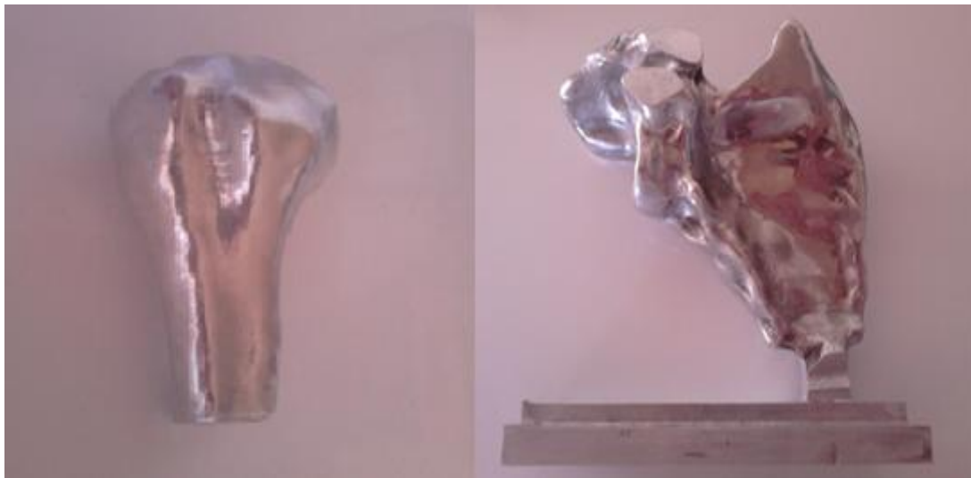
Εικόνα 5.3 Ακριβείς προτυποποίηση με NC/CNC κατεργασία.
