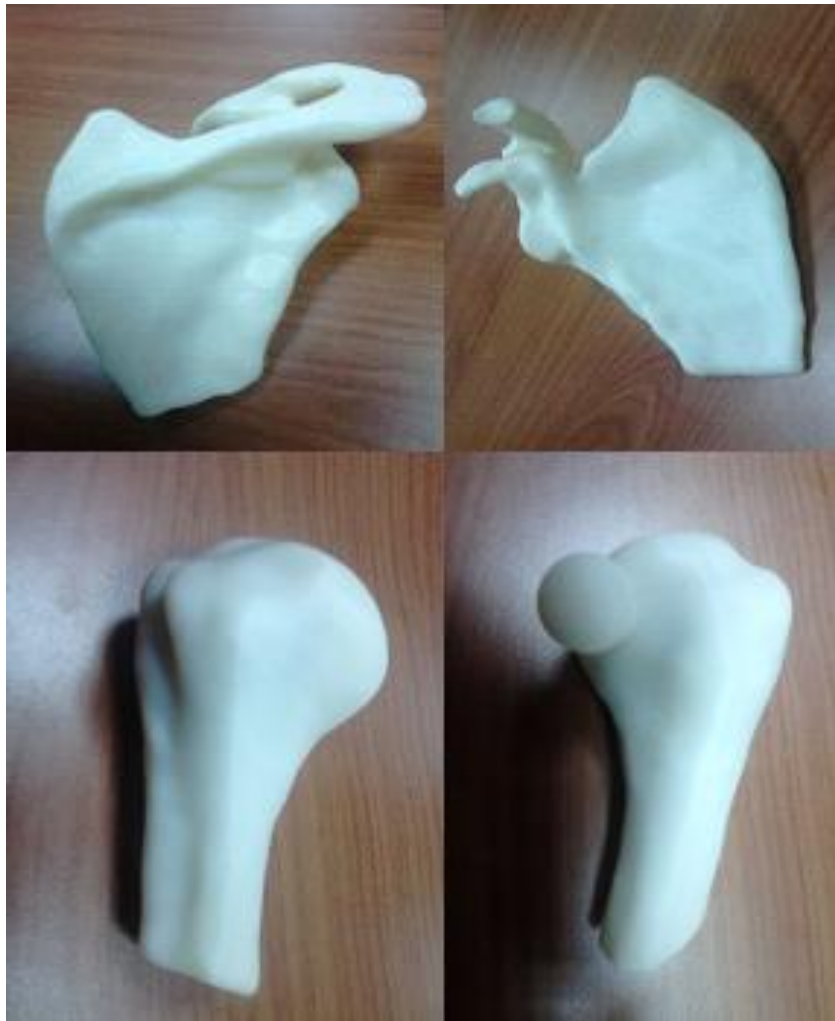
Εικόνα 4.14 Μετά την αφαίρεση του υποστηρικτικού υλικού.
