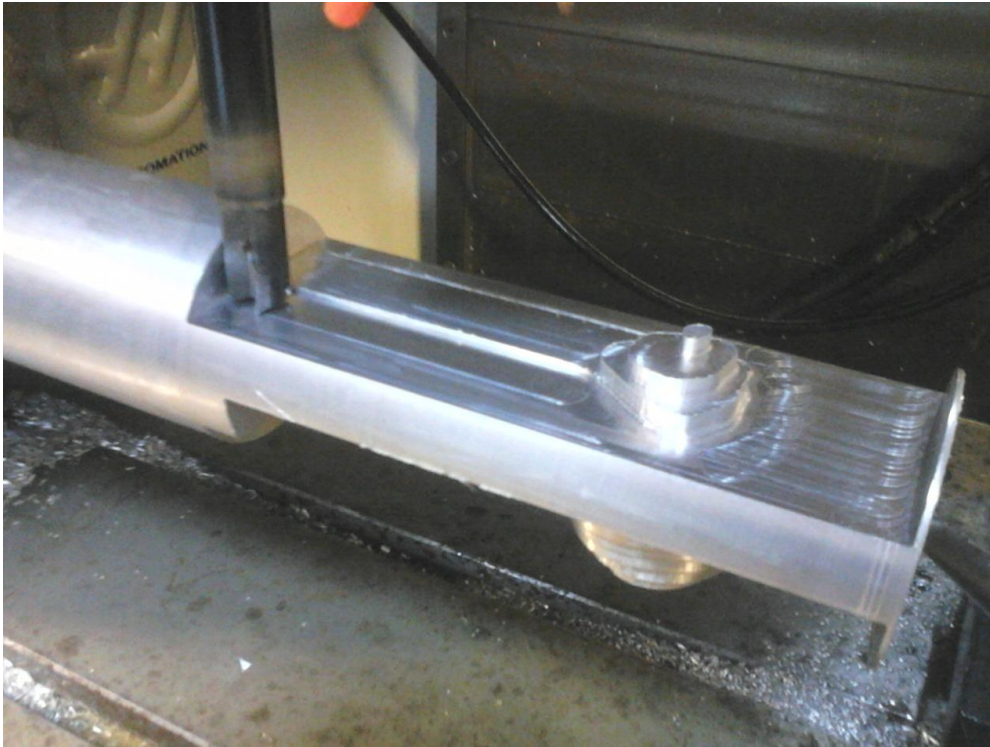
Εικόνα 4.26 Περιστροφή του κομματιού κατά 180^\circ και ξεχόνδρισμα από την άλλη μεριά.
