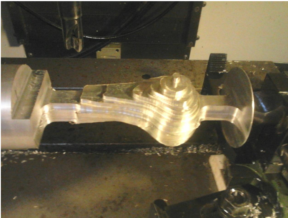
Εικόνα 4.27 Τελικό αποτέλεσμα ξεχονδρίσματος.
