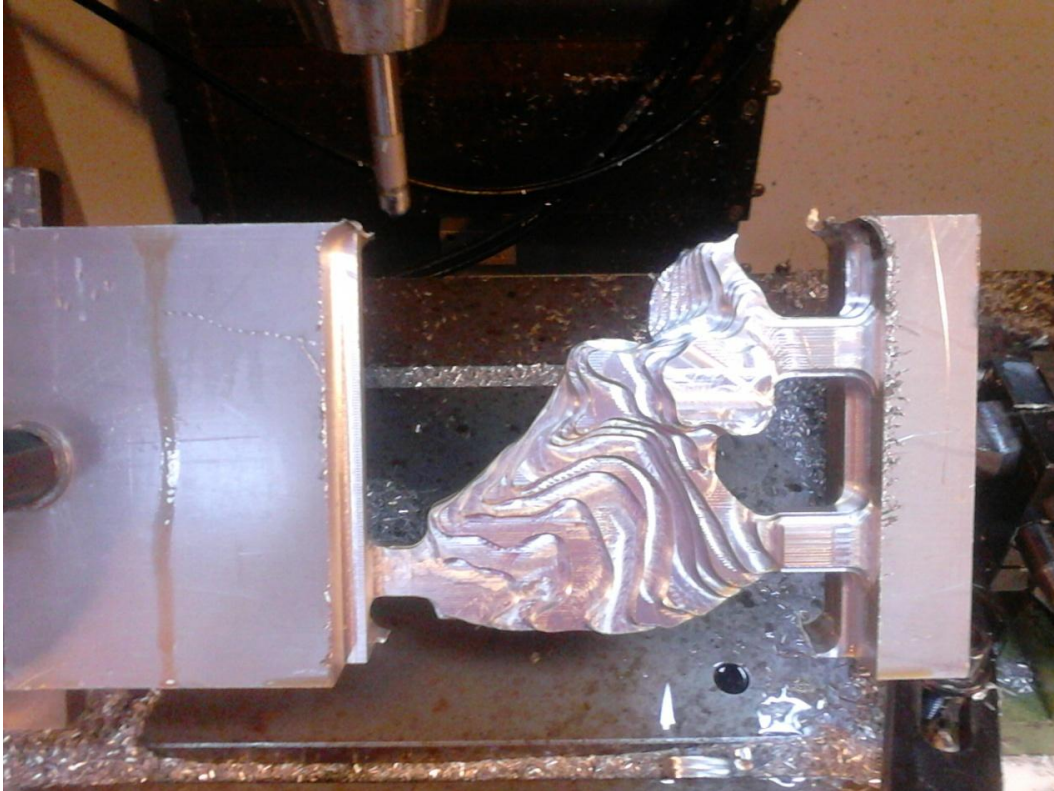
Εικόνα 4.36 Τελικό αποτέλεσμα ξεχονδρίσματος και από την άλλη μεριά.
