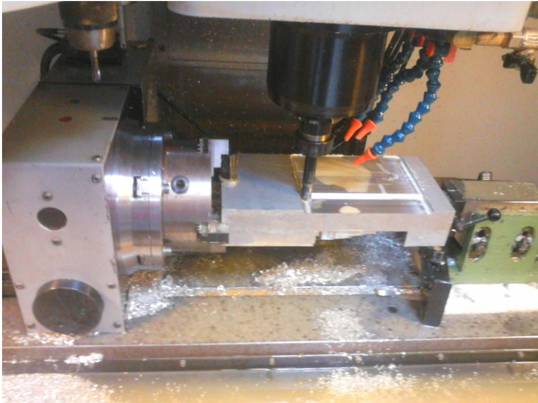
Εικόνα 4.32 Δέσιμο ακατέργαστου στην CNC μηχανή.
