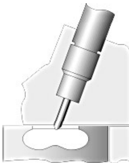
Θάλαμος καύσης κινητήρα απ' ευθείας έγχυσης
