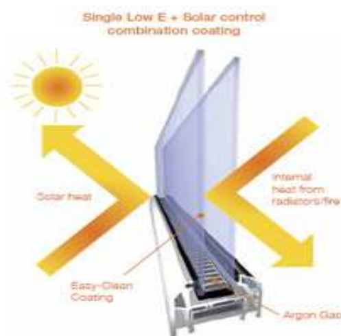
Δομή υαλοπίνακα υψηλής απόδοσης
