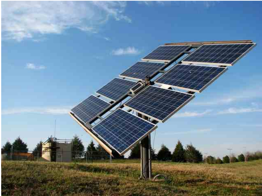
Εικόνα 1.11: Ηλιοτρόπιο (tracker) δυο αξόνων για την συνεχή παρακολούθηση του ήλιου.
