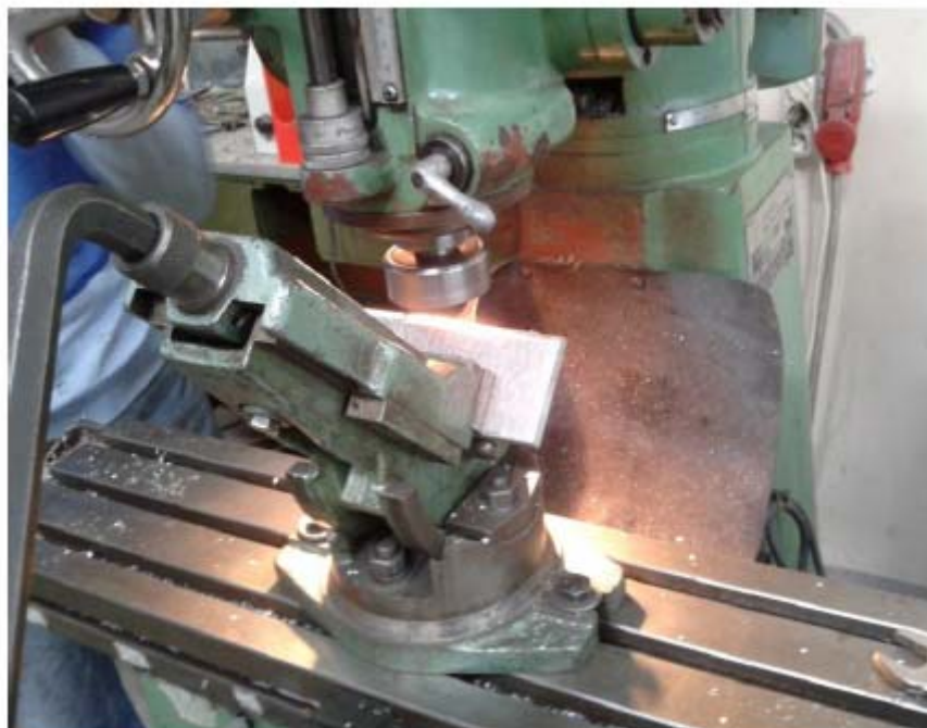
Σχήμα 12.5: Κατεργασία Φρεζαρίσματος λοξοτομής.
