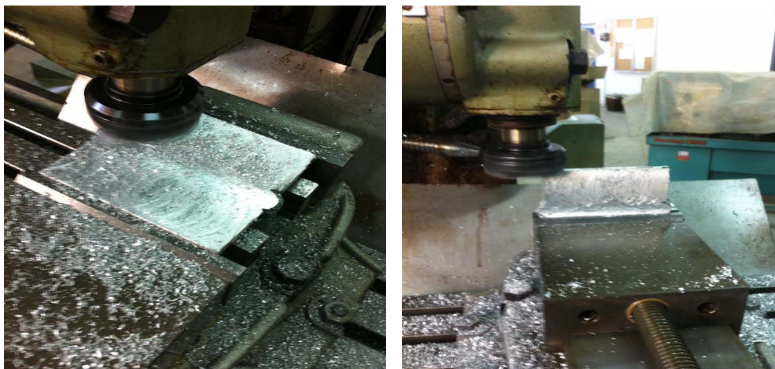
Σχήμα 12.7: Διαδικασία φρεζαρίσματος οριζόντιας και κάθετης πλευράς δοκιμίου
