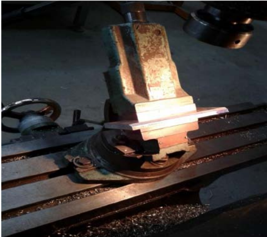
Σχήμα 12.4: Δοκίμο σε μέγγενη 45°.
