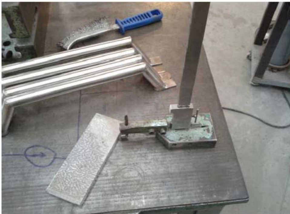
Σχήμα 12.3: Χάραξη Δοκιμίου στα 3 mm.
