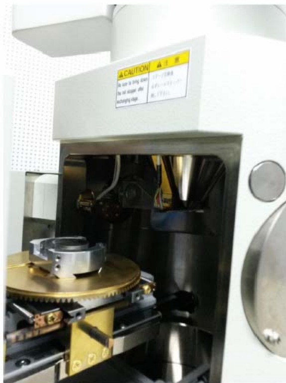
Σχήμα 13.3: Εσωτερική όψη μικροσκοπίου σάρωσης SEM.
