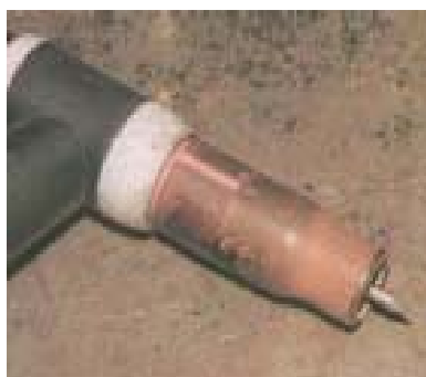
Σχήμα 4.7: Το μη αναλώσιμο ηλεκτρόδιο στην άκρη της τσιμπίδας
