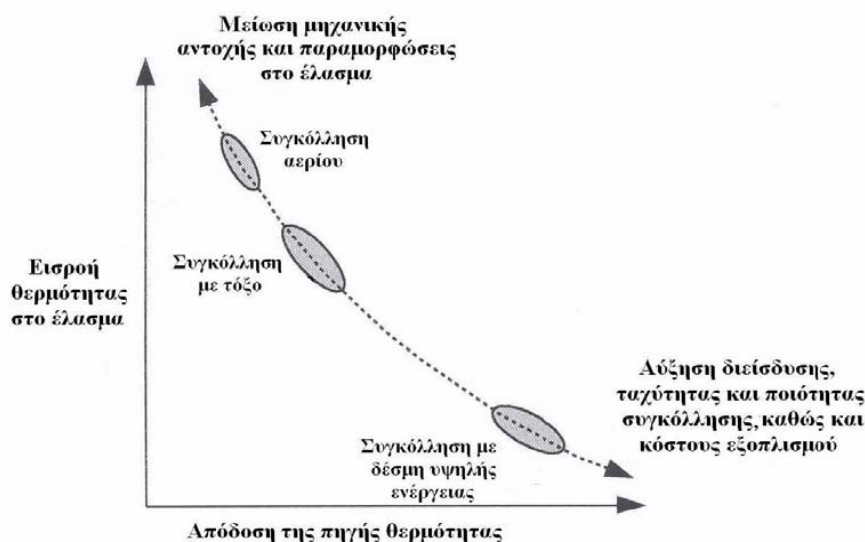
Σχήμα 5.3: Μεταβολή της θερμότητας που εισάγεται στο έλασμα σε σχέση με την απόδοση της πηγής.
