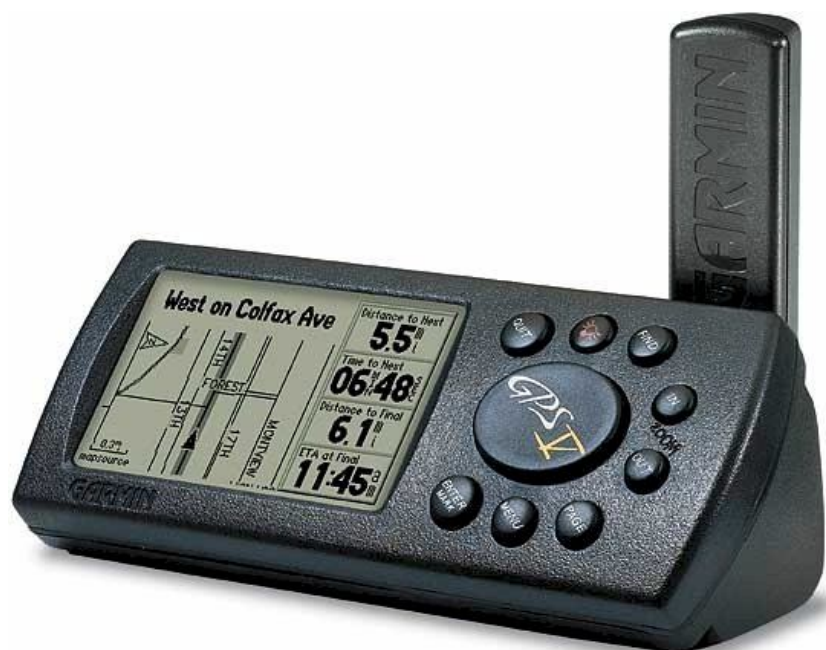
Εικόνα 2.Ο δέκτης GPS V της Garmin με την ενσωματωμένη κεραία
