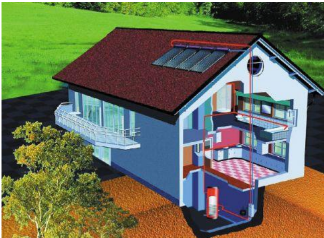
Εικόνα 1.11 Ηλιακοί συλλέκτες κατοικίας 21 .
