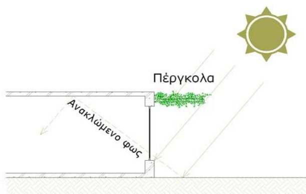
Εικόνα 1.10 Οριζόντιο σκίαστρο σε συνδυασμό με πέργκολα με φυτά.
