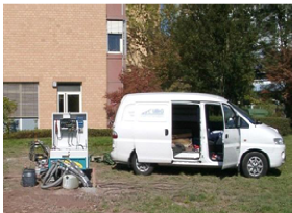
Εικόνα 1.6. Παράδειγμα δοκιμή θερμικής απόκρισης για τον προσδιορισμό των παραμέτρων του εδάφους (αριστερά) και τον υπολογισμό της διάταξης των κατακόρυφων γεωεναλλακτών θερμότητας χρησιμοποιώντας λογισμικό EED.
