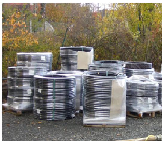
Εικόνα 1.5. Παραδείγματα προϊόντων για αντλίες θερμότητας: προκατασκευασμένοι κατακόρυφοι γεωεναλλάκτες θερμότητας που δοκιμάζονται και διανέμονται στο χώρο γεώτρησης (Φωτογραφίες αριστερά: Haka, κέντρο: Rehau).
