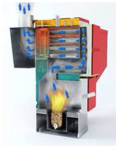
Εικόνα 3.11 : Λέβητας βιομάζας (Pellet)
