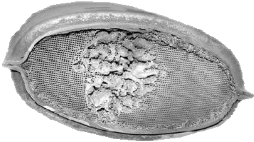
Βλάβη καταλύτη από μπουζοκαλώδιο.
