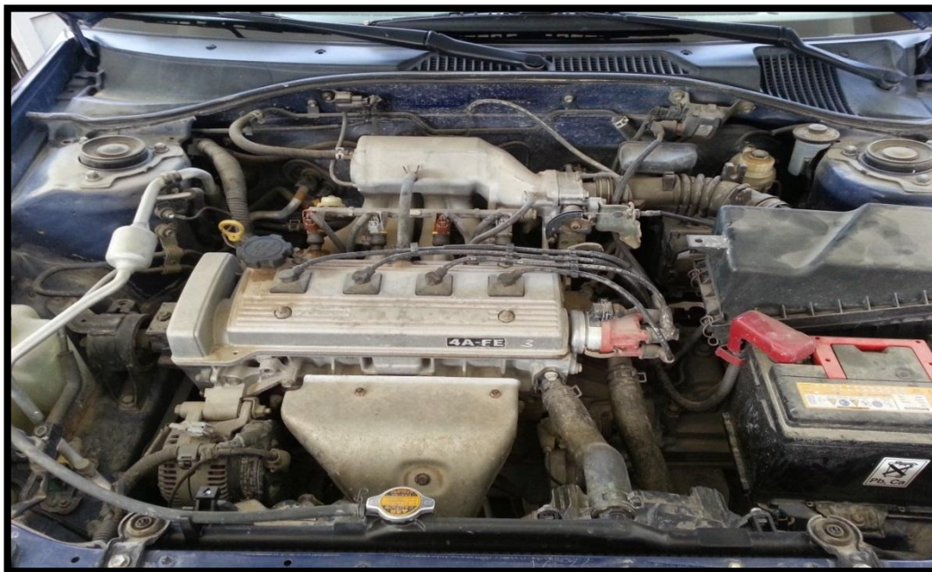
Toyota Avensis μοντέλο 2008-2012 με κινητήρα 4AFE και σύστημα ψεκασμού Bosch Motronic MP5.3
