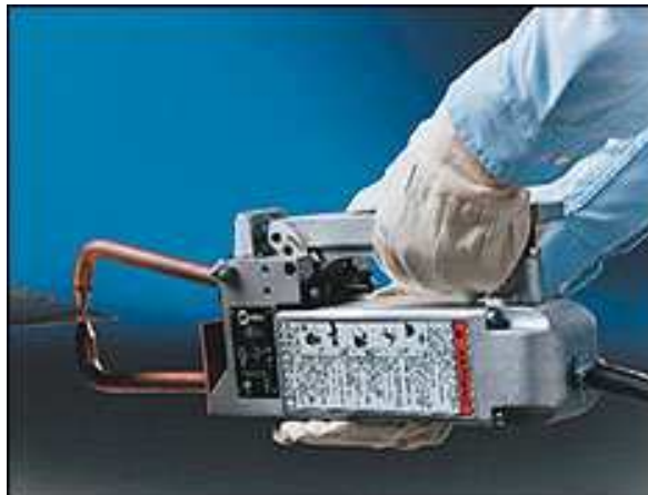
Σχήμα 4.1 : Φορητή συσκευή συγκόλλησης με αντίσταση
