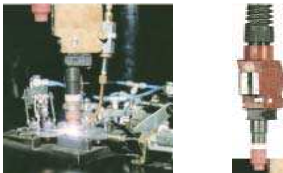
Σχήμα (9.2): Ρομποτικό σύστημα που βασίζεται στην TIG και η μορφή της τσιμπίδας
