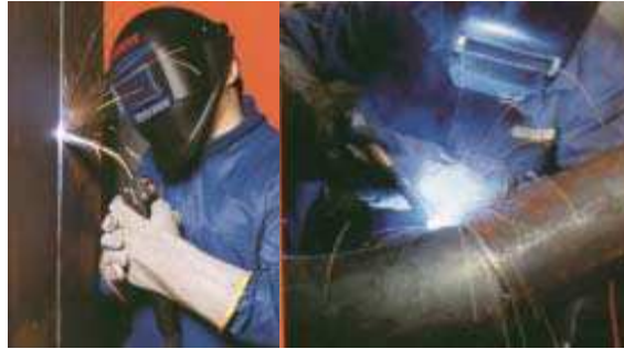
Σχήμα (4.3.3): Προσθήκη μετάλλου με σύρμα κατά τη MIG/MAG ή την FCAW
