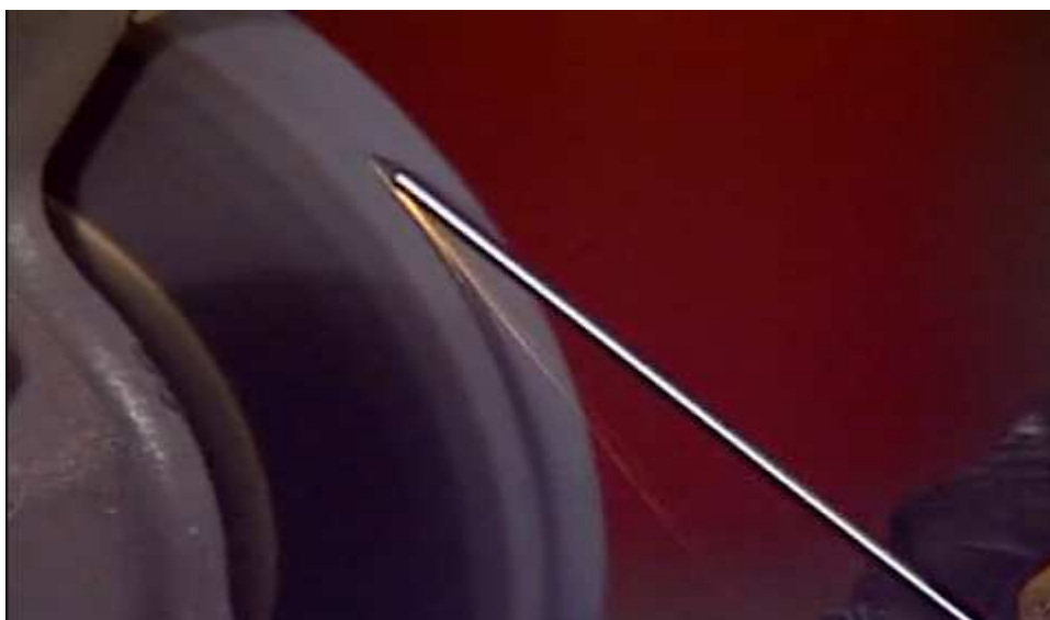
Σχήμα (7.5): Ο τρόπος που τροχίζεται το μη αναλώσιμο ηλεκτρόδιο για το σχηματισμό της αιχμής.
