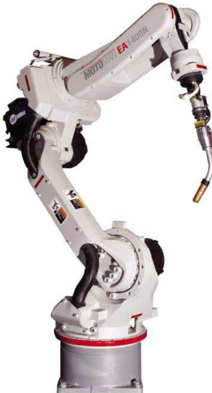
Σχήμα 9.4 Ρομποτικός βραχίονας συγκόλλησης με 6 βαθμούς ελευθερίας.
