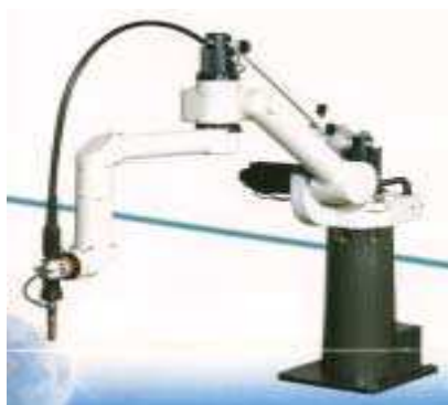
Σχήμα (9.3): Σύγχρονο ρομπότ 6 αξόνων (εκτελεί 6 διαφορετικές κινήσεις).
