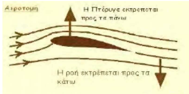
Εικόνα 3-9 Η αντίδραση από την διαρροή της ροής προς την κάτω πλευρά της αεροτομής είναι ο λόγος που δημιουργείται η απαιτούμενη άντωση για την πτήση.
