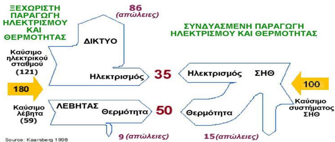
Σχήμα 4.1: Συμβατικό σύστημα σε σύγκριση με σύστημα συμπαραγωγής (30)
