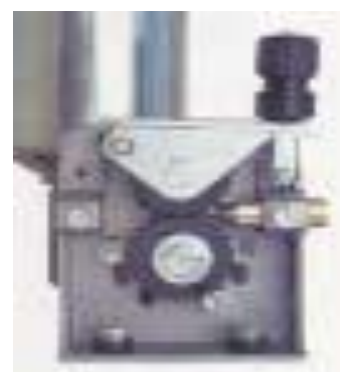
Εικόνα 5.3 Διάφορα συστήματα ράουλων προώθησης-τάνυσης του σύρματος
