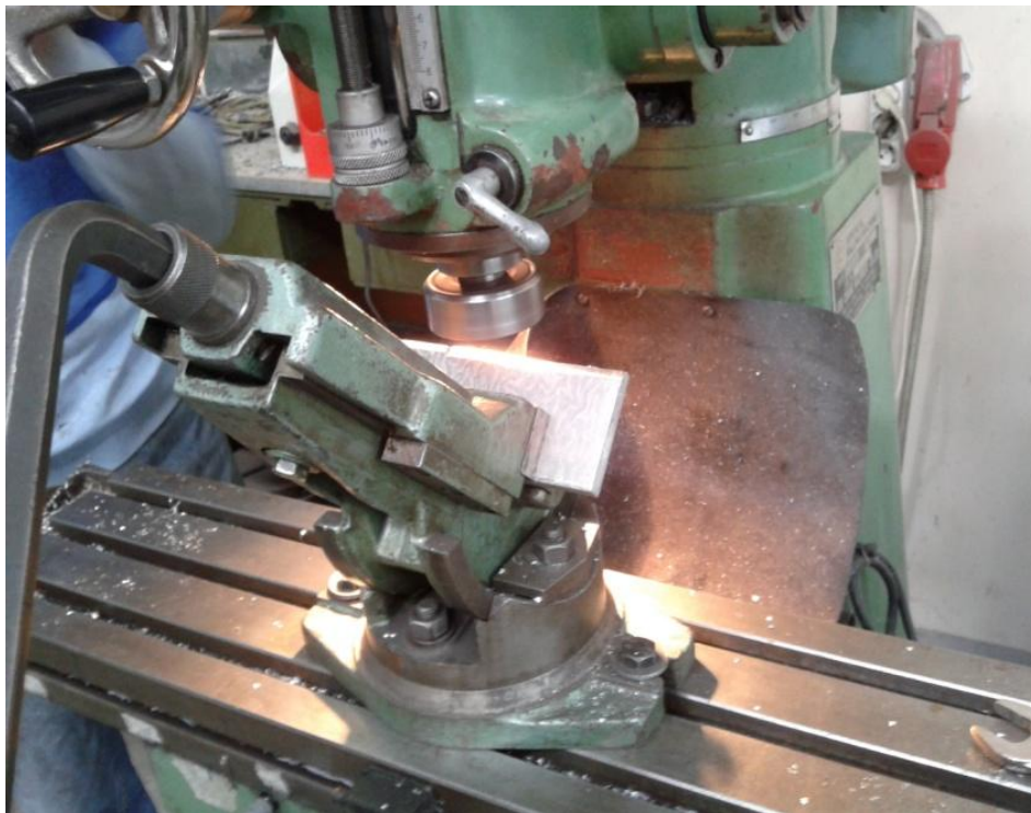
Εικόνα 13.5 Κατεργασία φρεζαρίσματος λοξοτομής
