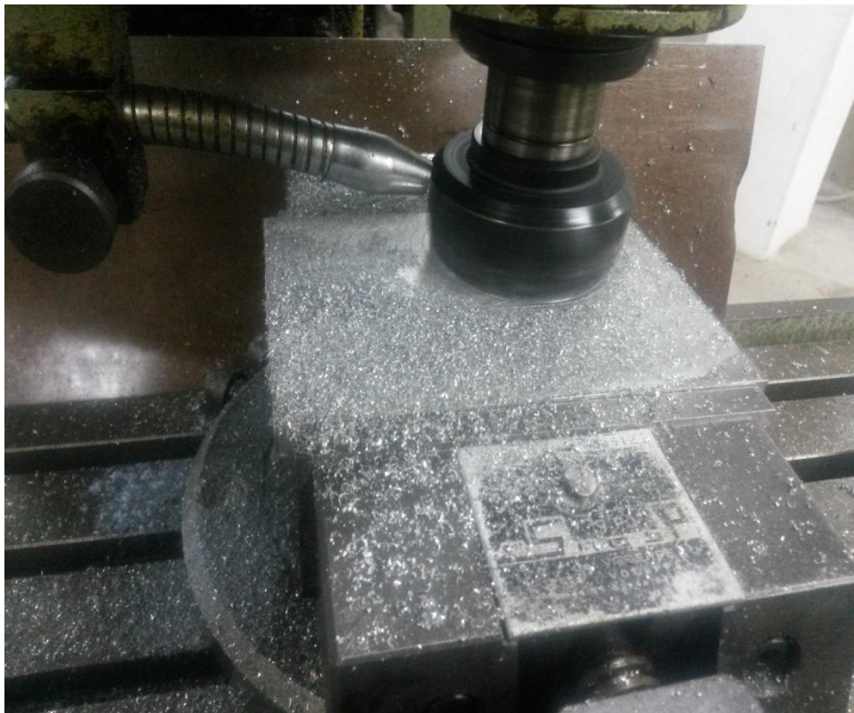
Εικόνα 13.11 Διαδικασία φρεζαρίσματος οριζόντιας πλευράς δοκιμίου
