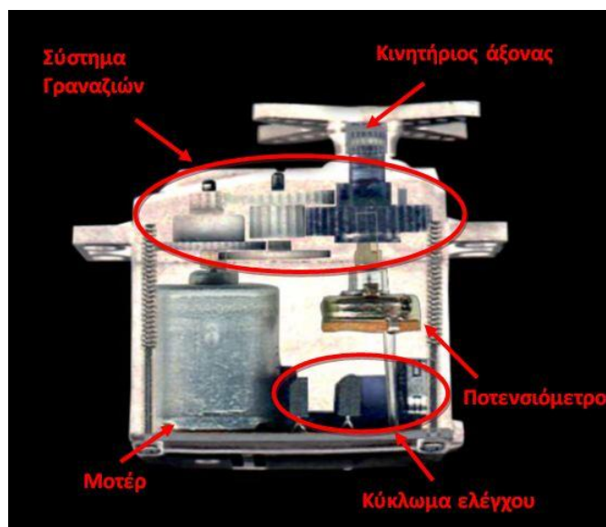
Εικόνα 3.4.1 Η ανατομία ενός σερβοκινητήρα RC servo
