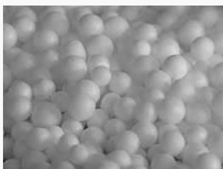
Εικόνα 11. Σφαιρίδια διογκωμένης πολυστερίνης διαμέτρου περίπου 2 χιλιοστών.
