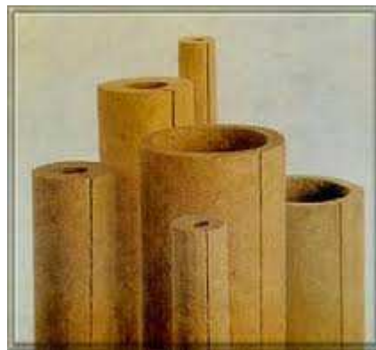
Εικόνα 38. Τα κοχύλια πετροβάμβακα διατίθενται με ή χωρίς επικάλυψη αλουμινίου και χρησιμοποιούνται για θερμο-ηχομόνωση σωλήνων σε βιομηχανικές εφαρμογές όπου υπάρχουν ιδιαίτερες απαιτήσεις προστασίας λόγω υψηλών θερμοκρασιών.
