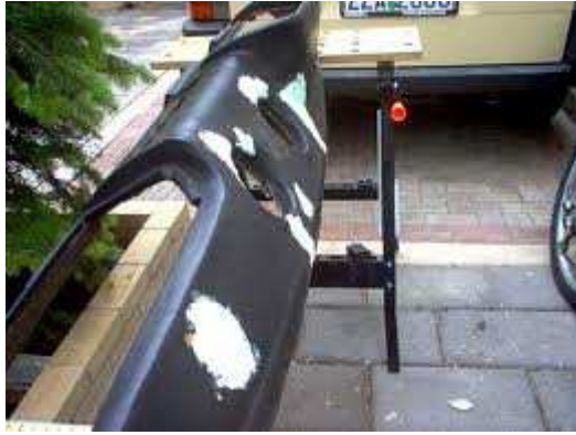
Εικόνα 64. Αρχικά γεμίστηκαν τα κενά με αφρό πολυουρεθάνης.
