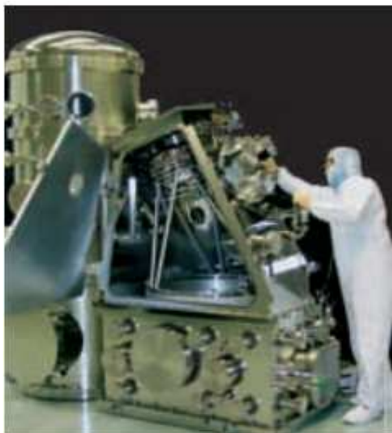
Πρωτότυπο εγκατάστασης βηματικού αποτυπωτή EUV για τη παραγωγή τσιπ μελλοντικών γενεών.
