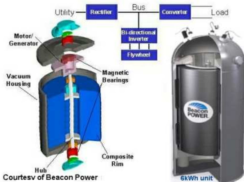
Τυπική διάταξη μίας μονάδας flywheel.
