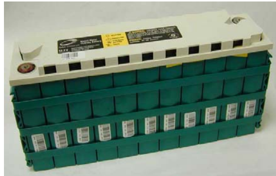
Εικόνα 58: Μπαταρία νικελίου - υβριδίου μετάλλου
