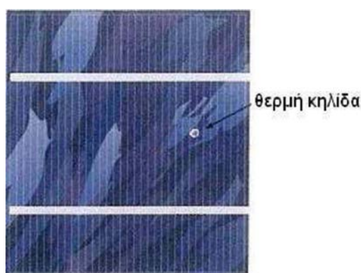
Εικόνα 2.9: Απεικόνιση θερμής κηλίδας
