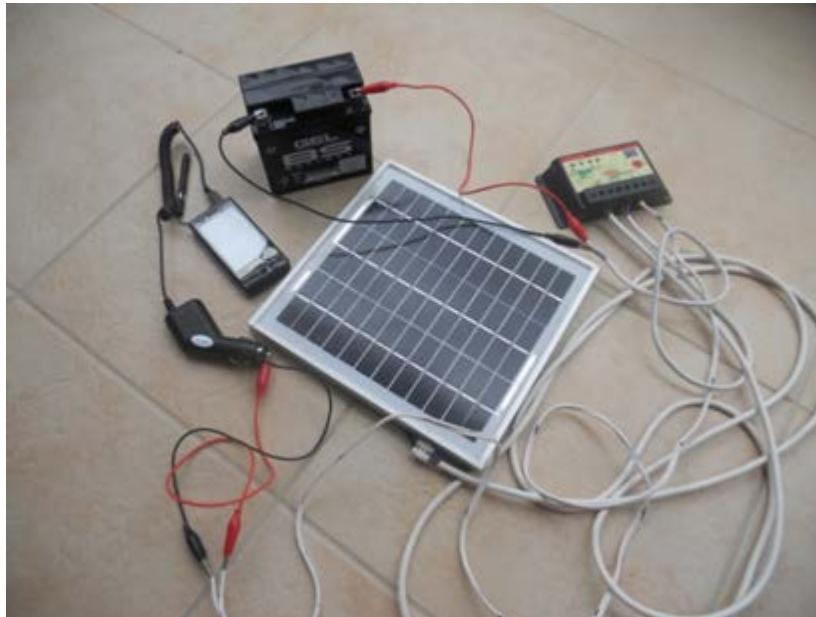
Εικόνα 9.15: Συνδεσμολογία φωτοβολταϊκού πάνελ, regulator, μπαταρίας, και φορτιστή αυτοκινητού
