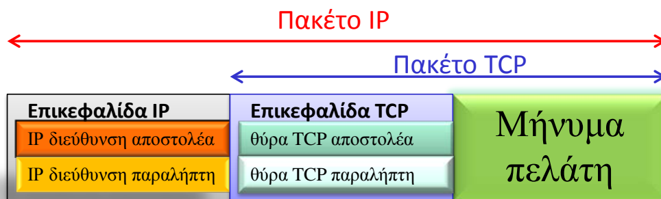
Εικόνα 5.13. Η δομή ενός IP πακέτου
