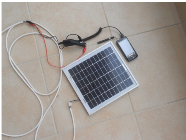
Εικόνα 9.24: Συνδεσμολογία φωτοβολταϊκού πάνελ, και φορτιστή κινητού
