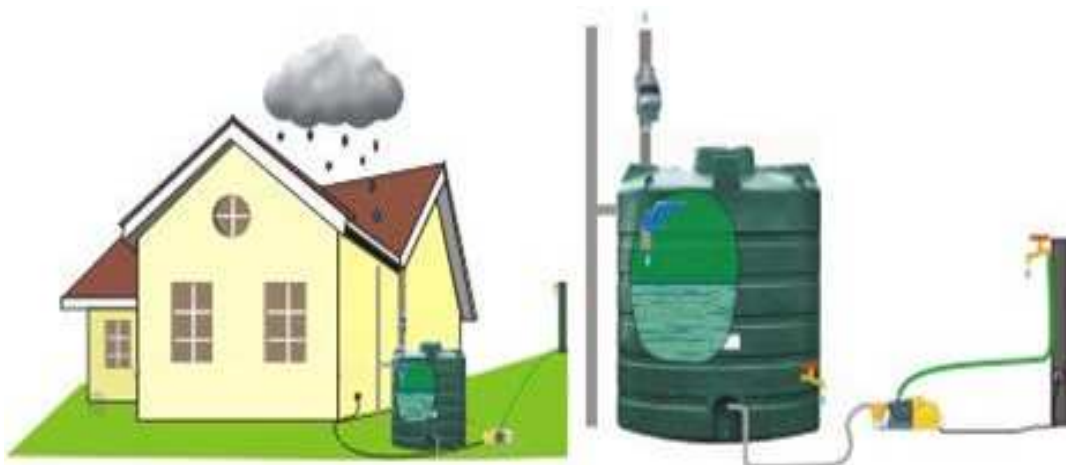
Εικόνα 12.3 : Υπέργεια δεξαμενή βρόχινου νερού με αντλία
