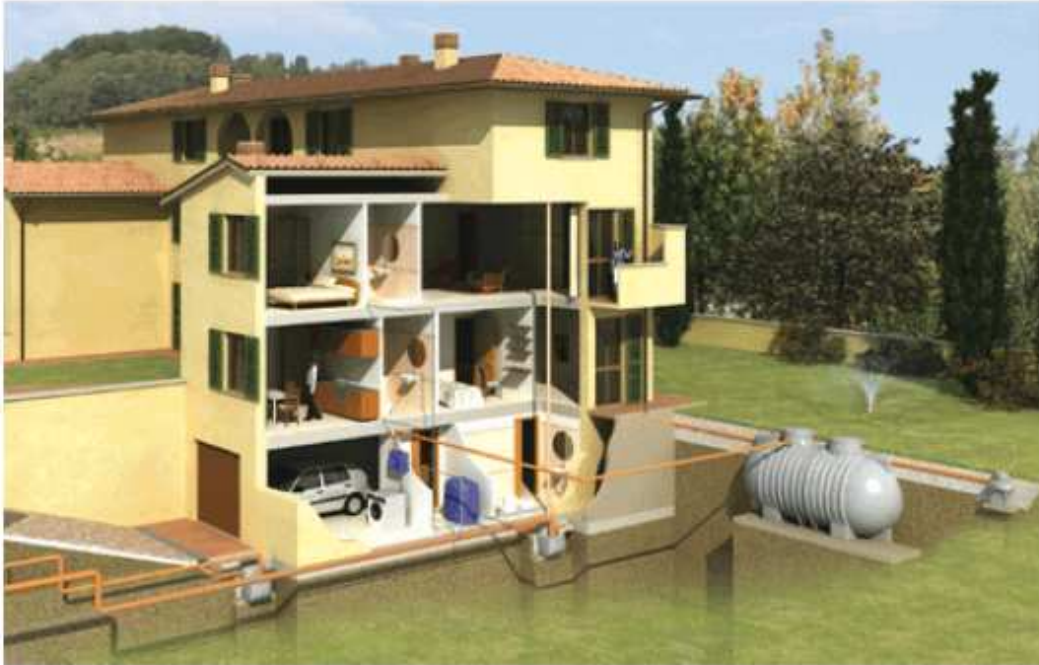
Εικόνα 12.21 : Σύστημα “Super- Rain” σε κατοικία.
