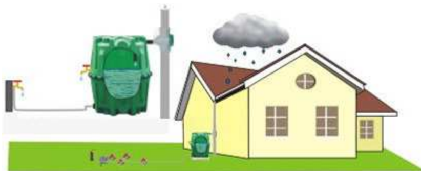
Εικόνα 12.2 : Υπέργεια δεξαμενή συλλογής βρόχινου νερού
