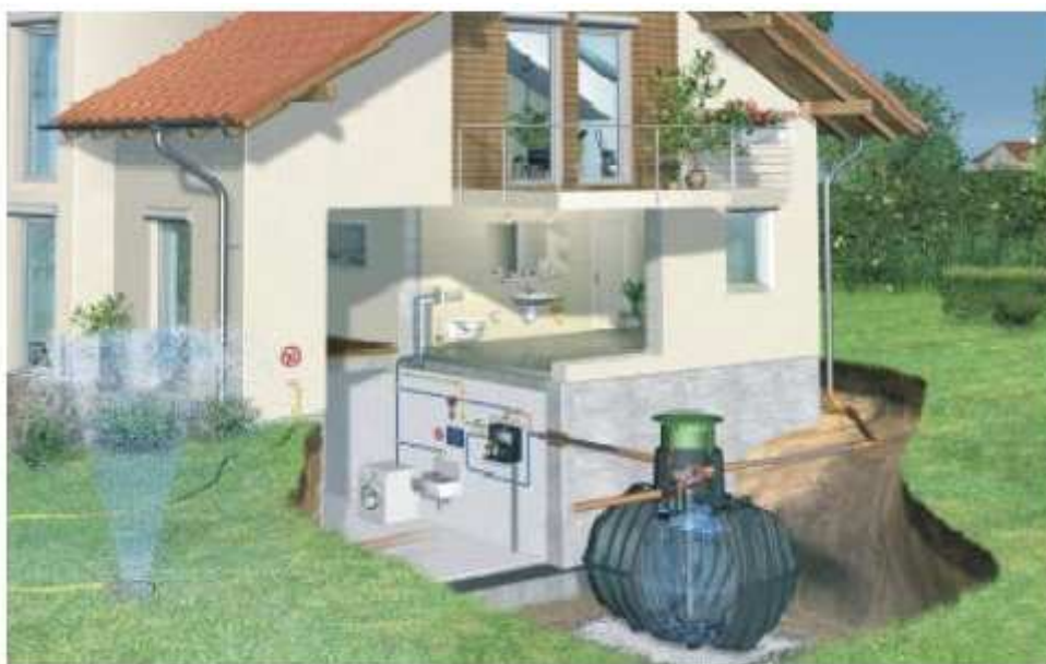
Εικόνα 12.7 : Ολοκληρωμένο σύστημα αξιοποίησης βρόχινου νερού
