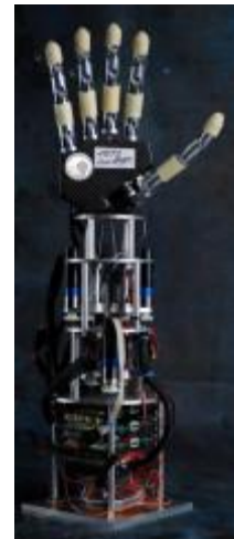
Εικόνα 2.3.3 το EH1 Milano Hand σε έκταση, στη βάση του διακρίνονται οι επενεργητές
