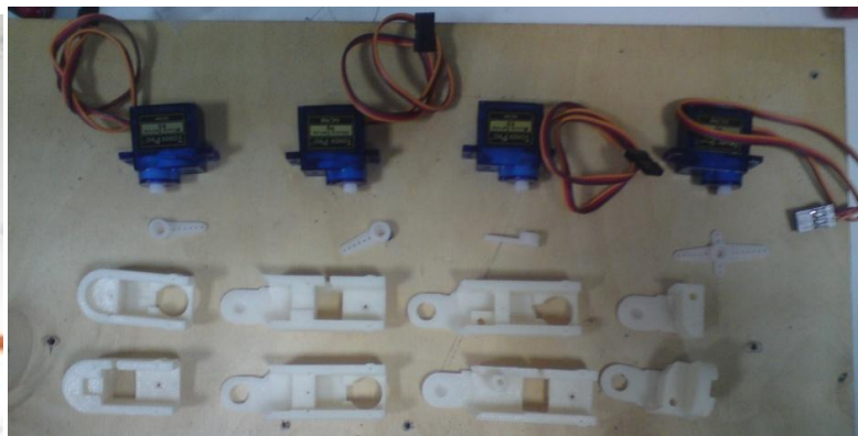
Εικόνα 5.2.5.4 τα τμήματα που αποτελούν τον αντίχειρα
