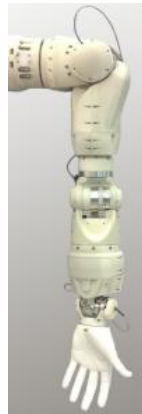
Εικόνα 2.3.5 το Elu-2 Arm προσαρμοσμένο σε ένα βραχίονα ανθρωπόμορφου ρομπότ
