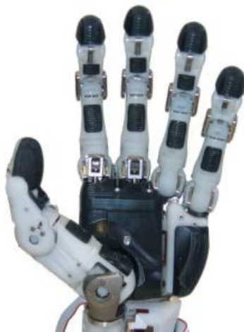
Εικόνα 2.3.2 το Elu-2 Hand σε έκταση, ενώ διακρίνονται τα ελαστικά του μέρη
