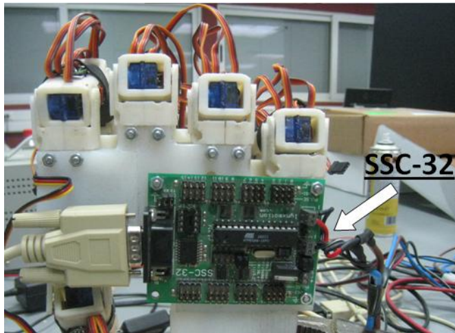
Εικόνα 4.1.12 Ο SSC-32 προσαρμοσμένος στη ραχιαία επιφάνεια του οπίσθιου τμήματος της παλάμης
