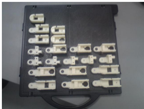
Εικόνα 5.2.5.1 τμήματα των δαχτύλων που κατασκευάστηκαν από τον 3D Printer στα οποία δεν έχουν αφαιρεθεί τα στηρίγματα
