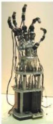
Εικόνα 2.3.4 το Actuated Sheffield Hand σε μερική κάμψη, στη βάση του διακρίνονται οι επενεργητές
