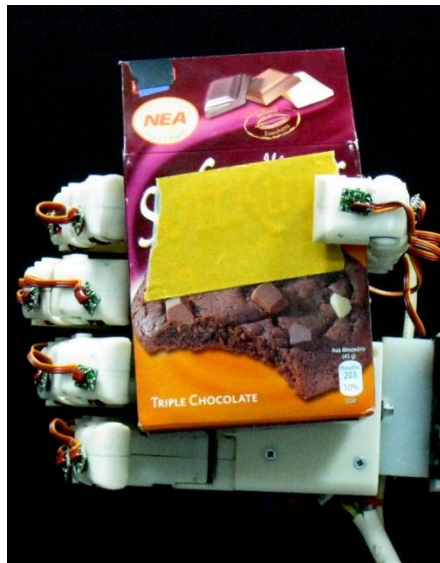
Εικόνα 4.2.2.4 λαβή ρομποτικού χεριού με κουτί
