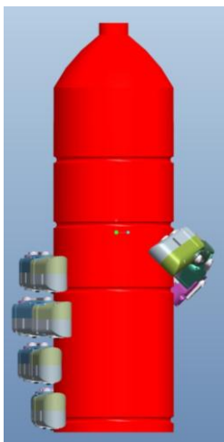
Εικόνα 5.2.4.1 εικονικό πείραμα λαβή μπουκαλιού, με τον αντίχειρα απέναντι και αντικριστά από τον δείκτη σχηματίζοντας γωνιά με αυτόν 45^\circ μοιρών
