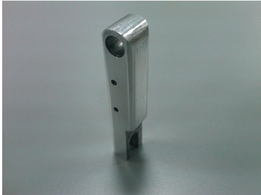
Εικόνα 60. Το ζυγόθρο έχει πάρει την τελική του μορφή μετά από κατεργασία σε φρέζα
