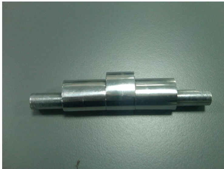
Εικόνα 56. Ο εκκεντροφόρος άξονας ολοκληρωμένος και έτοιμος για χρήση
