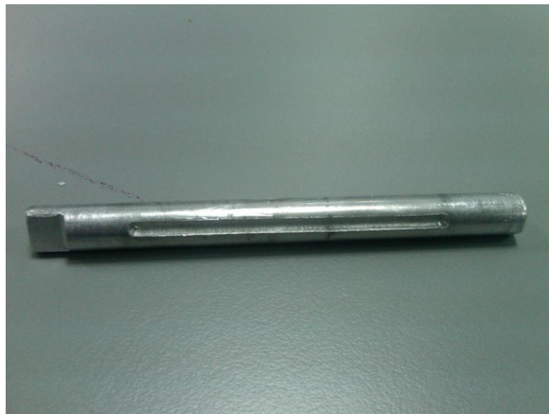
Εικόνα 54. Στην εικόνα φαίνεται ο σφηνόδρομος που δημιουργήθηκε κατά μήκος του άξονα για την στήριξη των έκκεντρων
