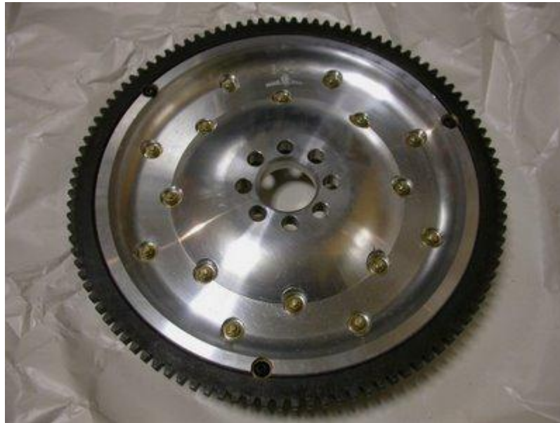
Εικόνα 11 Σφόνδυλος (Βολάν) κατασκευασμένος από αλουμίνιο. Στην περιφέρεια του βρίσκεται η οδοντωτή στεφάνη στην οποία εμπλέκεται η μίζα
