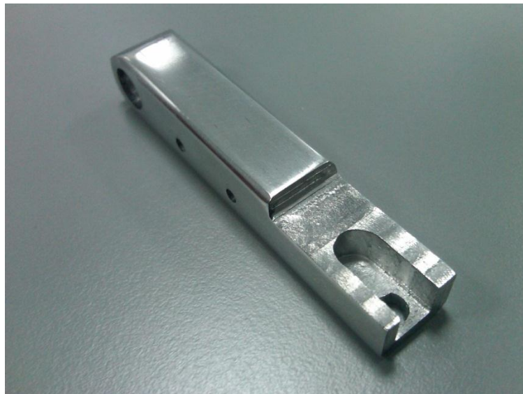
Εικόνα 81. Το ζύγωθρο μετά την κατεργασία σε φρέζα για την δημιουργία του οδηγού
