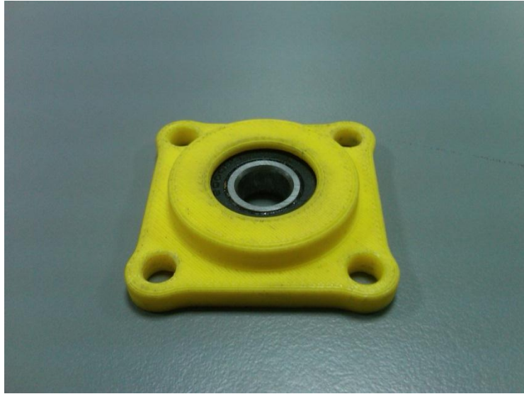
Εικόνα 65. Το έδρανο στήριξης τοποθετημένο στην βάση που το συγκρατεί
