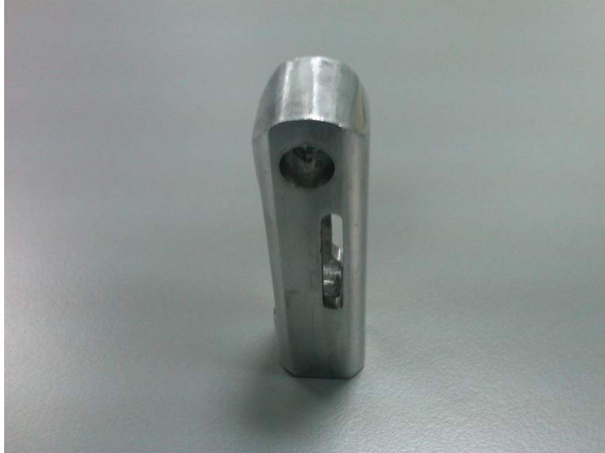
Εικόνα 62. Κεντρικό ζυγώθρο μετά την κατεργασία σε φρέζα
