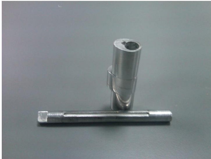
Εικόνα 55. Ο άξονας με τα έκκεντρα πριν συναρμολογηθούν
