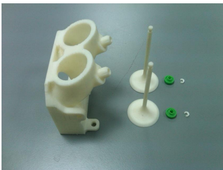
Εικόνα 113. Το μοντέλο της κυλινδροκεφαλής με τις βαλβίδες και τα εξαρτήματα τους
