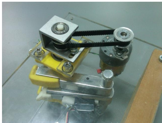
Εικόνα 91. Το σύστημα μετάδοσης κίνησης συναρμολογημένο
