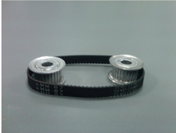
Εικόνα 94. Οι οδοντωτοί τροχοί με τον ιμάντα για τη μετάδοση της κίνησης πριν την τοποθέτηση
