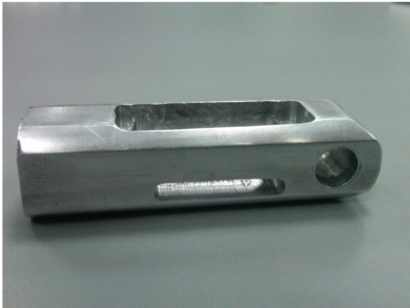
Εικόνα 73. Στο προφίλ του κεντρικού ζυγώθρου διακρίνεται ο οδηγός του πτερυγίου εμπλοκής μετά την κατασκευή του σε φρέζα
