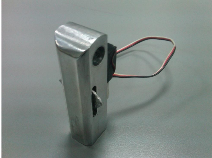
Εικόνα 74. Το κεντρικό ζυγόθρο με το πτερόγιο εμπλοκής τοποθετημένο σε ανοιχτή θέση
