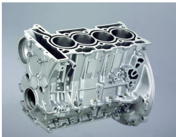
Εικόνα 7. Κορμός τετρακύλινδρου εν σειρά κινητήρα. Επίσης, διακρίνονται τα υδροχιτόνια των κυλίνδρων που αποτελούν ανεξάρτητο κομμάτι σε κινητήρες με αλουμινένιο κορμό
