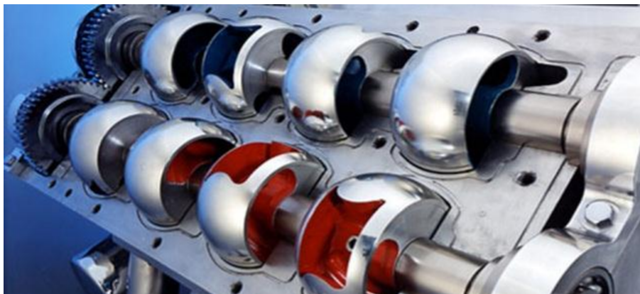
Εικόνα 17. Διάταξη με δύο επικεφαλής περιστροφικές βαλβίδες ανά κύλινδρο
