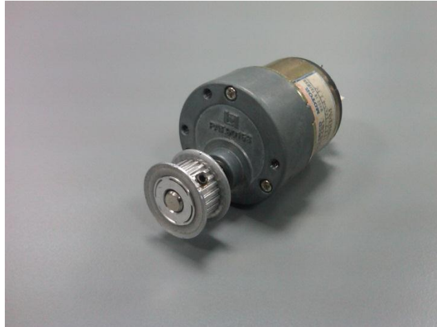
Εικόνα 90. Ο ηλεκτροκινητήρας συναρμολογημένος με τον οδοντωτό τροχό
