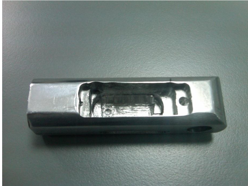
Εικόνα 72. Στην εικόνα διακρίνεται η κατεργασία στο εσωτερικό του κεντρικού ζυγώθρου για την αφαίρεση υλικού
