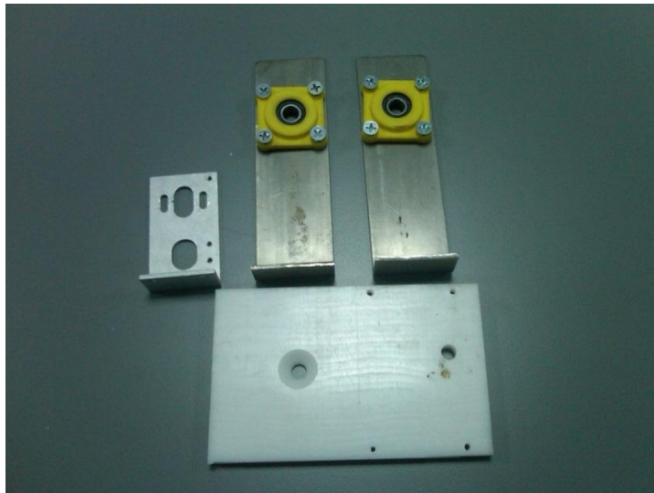
Εικόνα 88. Με υλικό κατασκευής το ανοξείδωτο ατσάλι επιτεύχθηκε η στιβαρότητας της κατασκευής
