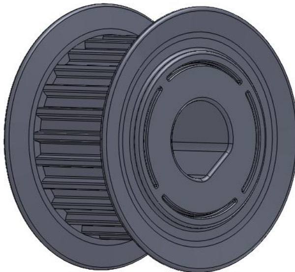
Εικόνα 95. Τρισδιάστατη απεικόνιση της τροχαλίας που μεταδίδει την κίνηση στον εκκεντροφόρο άξονα
