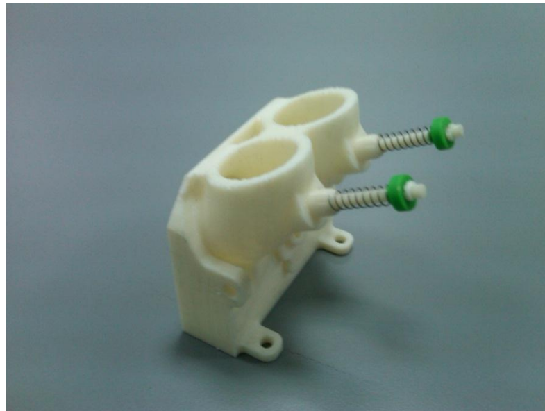
Εικόνα 115. Το μοντέλο της κυλινδροκεφαλής με τις βαλβίδες τοποθετημένες σε αυτό
