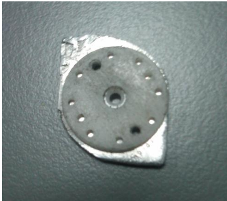
Εικόνα 71. Η τροχαλία επέκτασης του MICRO SERVO τοποθετημένη στο πτερύγιο εμπλοκής
