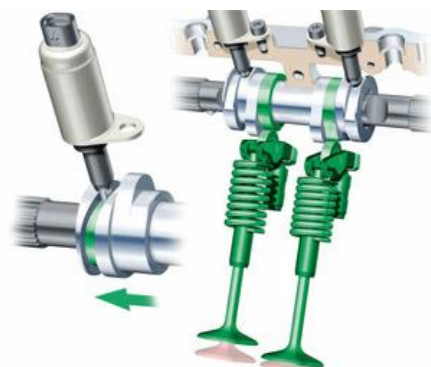
Εικόνα 40. Σύστημα μεταβλητού χρονισμού valvelift της Audi. Στο αριστερό μέρος φαίνεται ο ηλεκτρομαγνητικός πείρος σε λειτουργία
