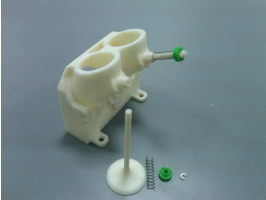
Εικόνα 114. Το μοντέλο της κυλινδροκεφαλής κατά την ώρα της συναρμολόγησης
