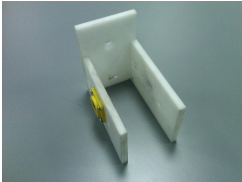
Εικόνα 86. Η αρχική κατασκευή της βάσης στήριξης που είχε σαν υλικό κατασκευής φύλλα πλαστικού Ertalon
