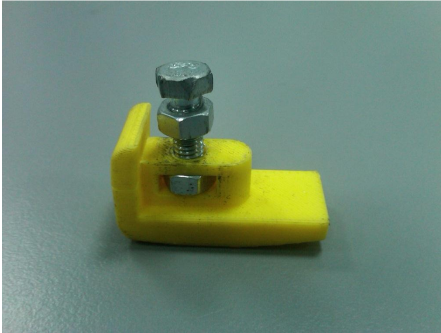
Εικόνα 80. Το κινούμενο στέλεχος κατασκευασμένο από ABS συναρμολογημένο με τον κοχλία που θα ρυθμίζει την θέση του
