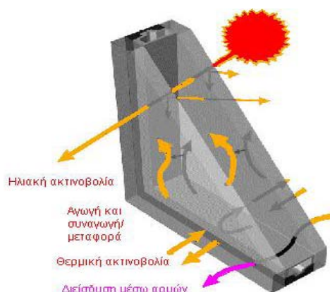
Σχήμα 5.3: Οι μορφές θερμικής ροής μέσω ενός κουφώματος.
