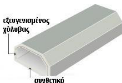
Σχήμα 9.16. Βελτιωμένος πήχης συγκράτησης υαλοστασίου από εξευγενισμένο χάλυβα με συνθετικό καπάκι.
